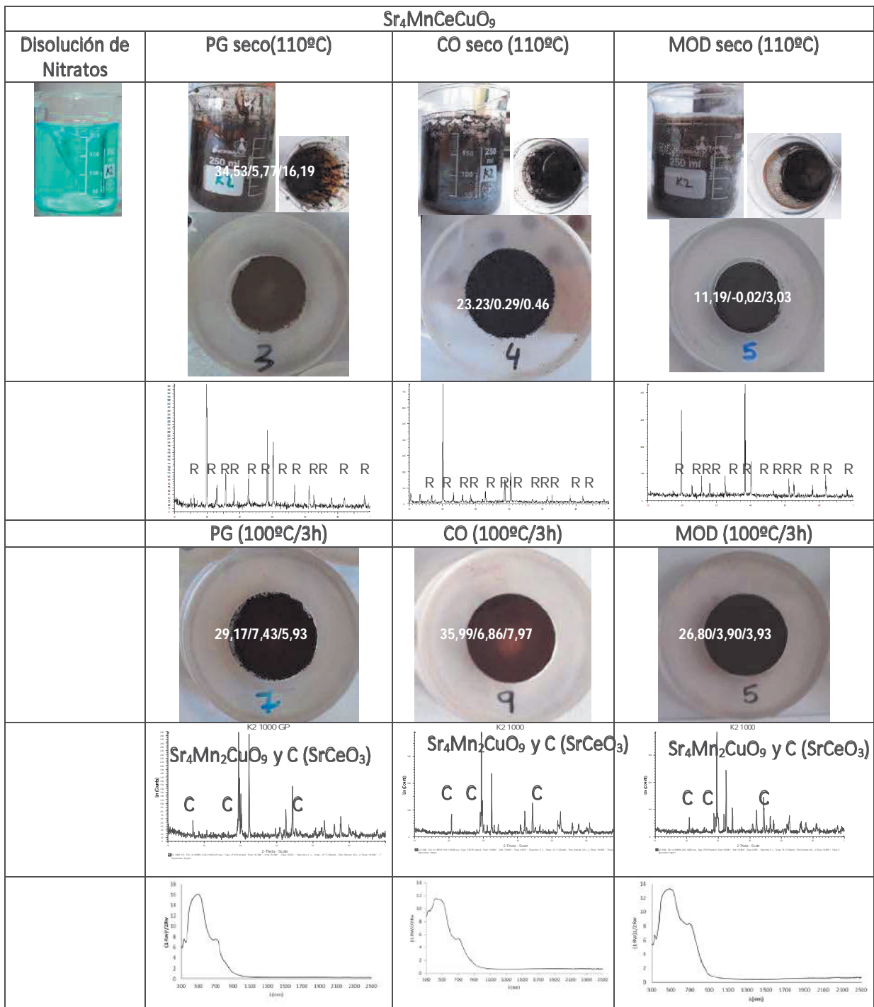
Figura 2. Composites secos Sr_4MnCeCuO_9 , incluyendo su L^*a^*b^* y difractograma de rayos X, así como calcinados a 1000°C/3h incluyendo los espectros Kubelka Munk de absorbancia óptica. Fases cristalinas: R(Sr(NO_3)_2) , C(SrCO_3)
