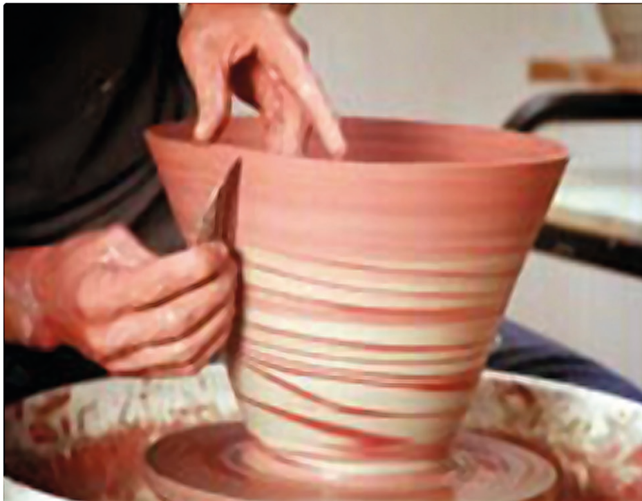
Imagen 30. Mezcla parcial de arcilla roja y loza. Neriage producido al torneare la pieza
