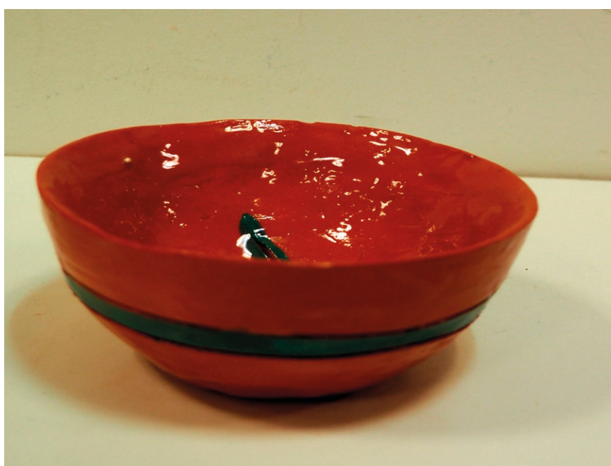
Imagen 124. Cuenco de arcilla roja con decoración de engobes y bizcochado a 840 °C. Posterior vidriado alcalino a 980 °C
