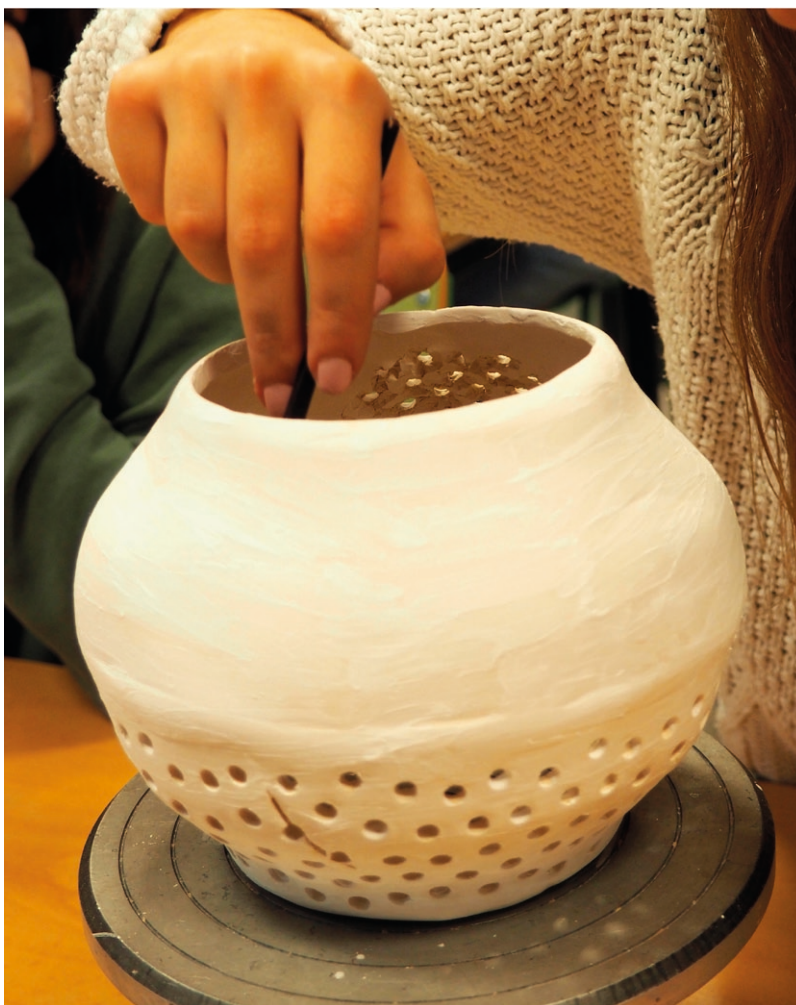
Imagen 96. Bizcochada y aplicación de vidriado transparente, todavía sin cocer
