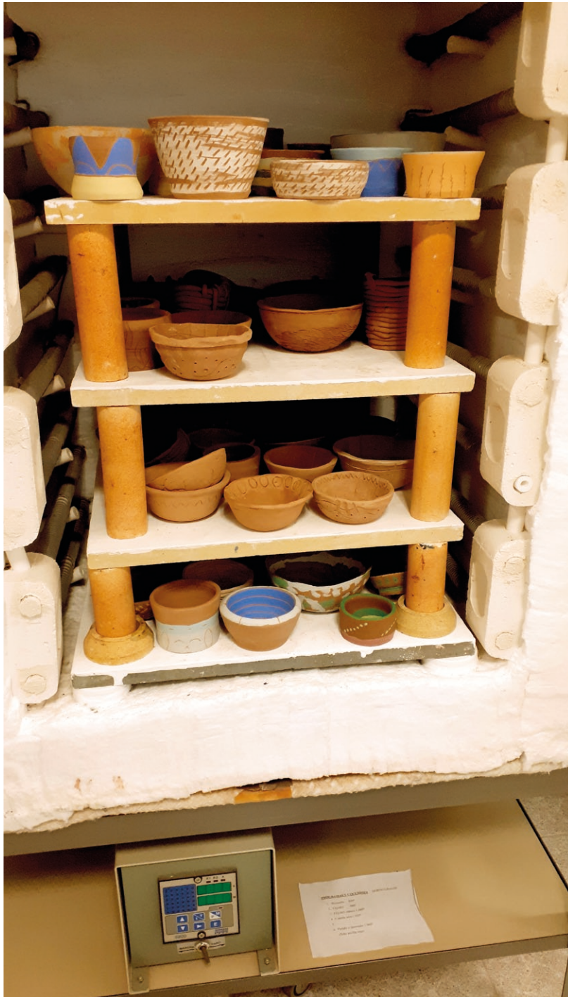
Imagen 140. Interior del horno cargándose para una cocción de bizcochado. Piezas de arcilla roja con engobes
