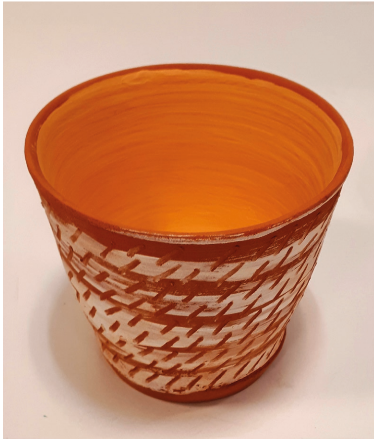
Imagen 105. Grabados en piezas secas, posterior a la aplicación de engobe
