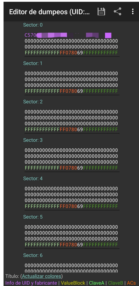
Figura 4.2: Resultado del escaneo con los datos sensibles censurados.
