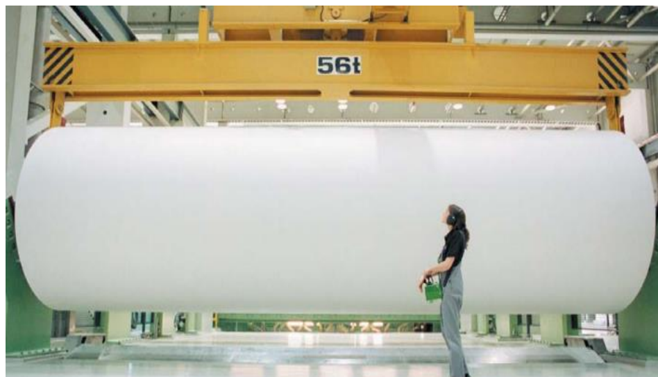
Figura 11. Formación de la bobina madre. Fuente: Aspapel, 2008.
