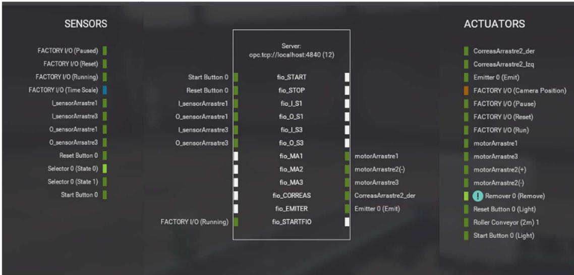
Figura 13: Relación de las variables del servidor con las locales del simulador
