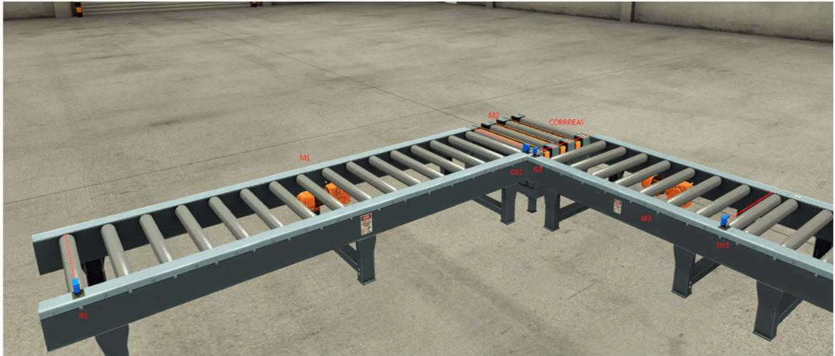
*Figura 32: Sistema desarrollado en Factory io del ejemplo Two Conveyors*
