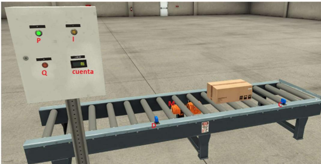
*Figura 52: Sistema desarrollado en Factory io del ejemplo contador lámpara*
