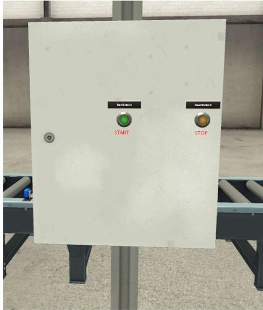
*Figura 34: Botonera marcha paro en Factory io para el sistema distribuido del ejemplo Two Conveyors*
