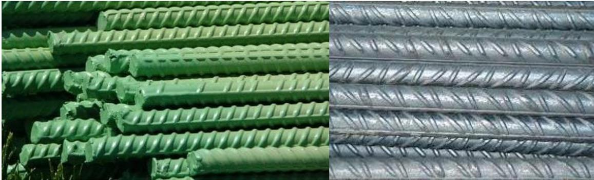
Figura 5. Barras de acero con pintura de epoxi (a la izquierda) y galvanizadas en zinc (a la derecha).
