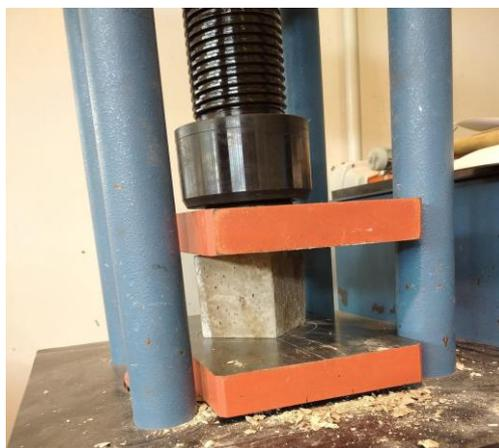
Figura 3.11. Imagen de la probeta cúbica en la máquina de ensayo.
