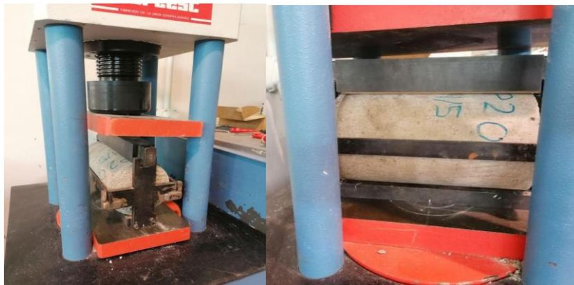
Figura 3.14. Imagen de la probeta cilíndrica en la máquina de ensayo.
