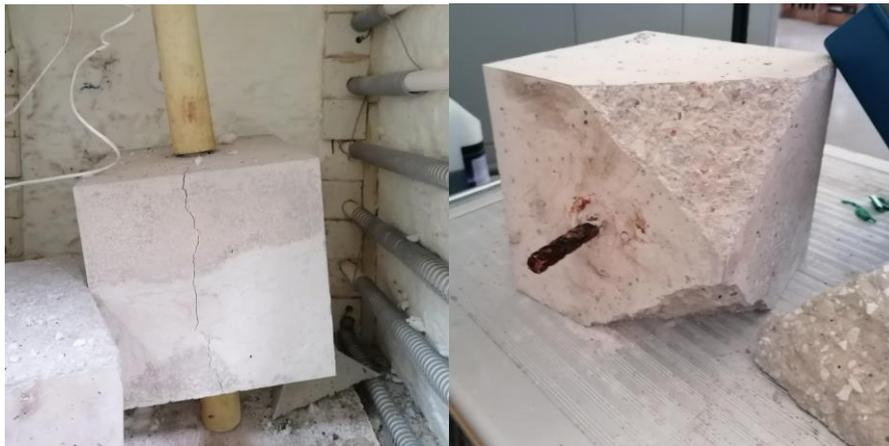
Figura 3.21. Imagen de la probeta de referencia después de calentarse a 600 °C.
