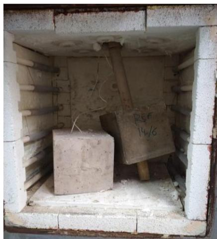
Figura 3.16. Imagen de los bloques de hormigón en el horno.
