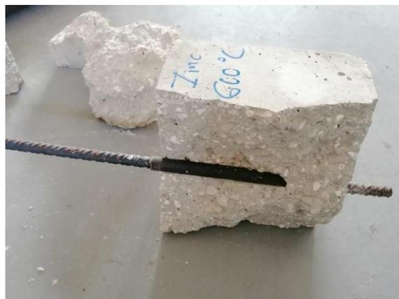
Figura 3.22. Imagen de la probeta de galvanizada en zinc después de calentarse a 600 °C.
