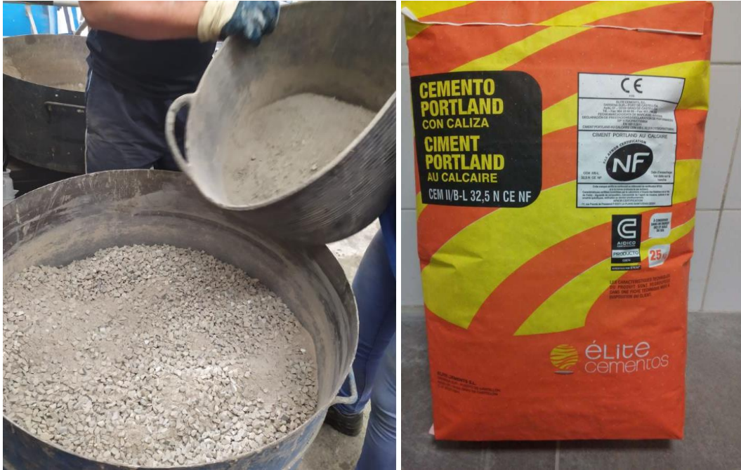
Figura 29. Izquierda: vertido de cemento. Derecha: cemento utilizado: CEM II/B-L 32,5 N de Élitecementos.
