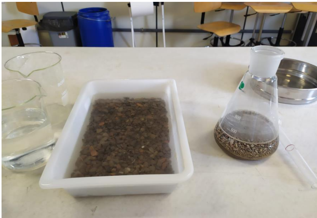
Figura 12. Grava y arena sumergidas para poder pesar la masa con superficie seca y saturada de agua. También para realizar sobre la arena el ensayo de densidad.
