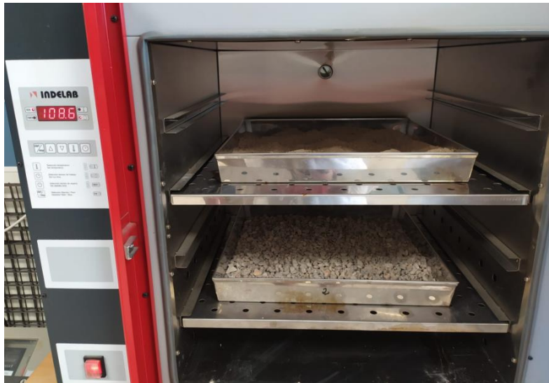
Figura 6. Secado de la muestra de áridos calizos (arena en la bandeja superior y grava en la inferior) previo al ensayo de granulometría.
