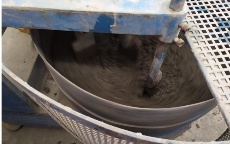
Figura 33. Mezcla de arena, grava, cemento y agua con fluidificante.
