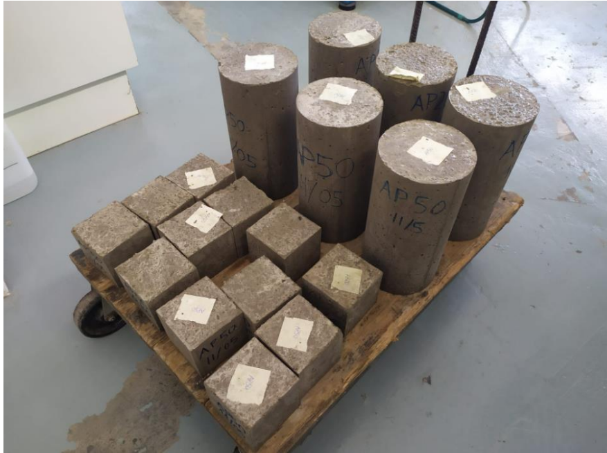
Figura 39. Transporte de las probetas del hormigón AP20 y AP50 a la cámara humidificadora.
