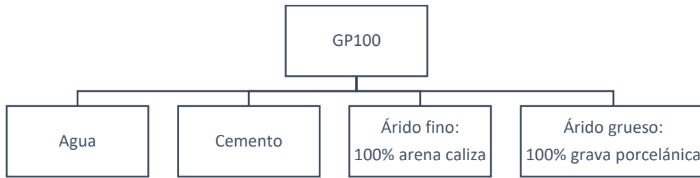
Figura 24. Composición del hormigón GP100.
