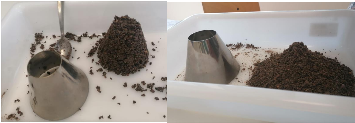
Figura 15. Izquierda: primer cono para comprobar la humedad de la arena caliza durante el ensayo de absorción. Muy compacto, por lo que existe aún mucha humedad. Derecha: segundo ensayo de cono para comprobar la humedad de la arena. Arena saturada, pero con superficie seca.
