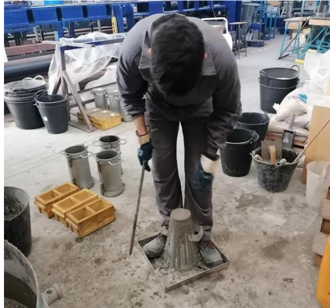
Figura 35. Primer ensayo de asentamiento.
