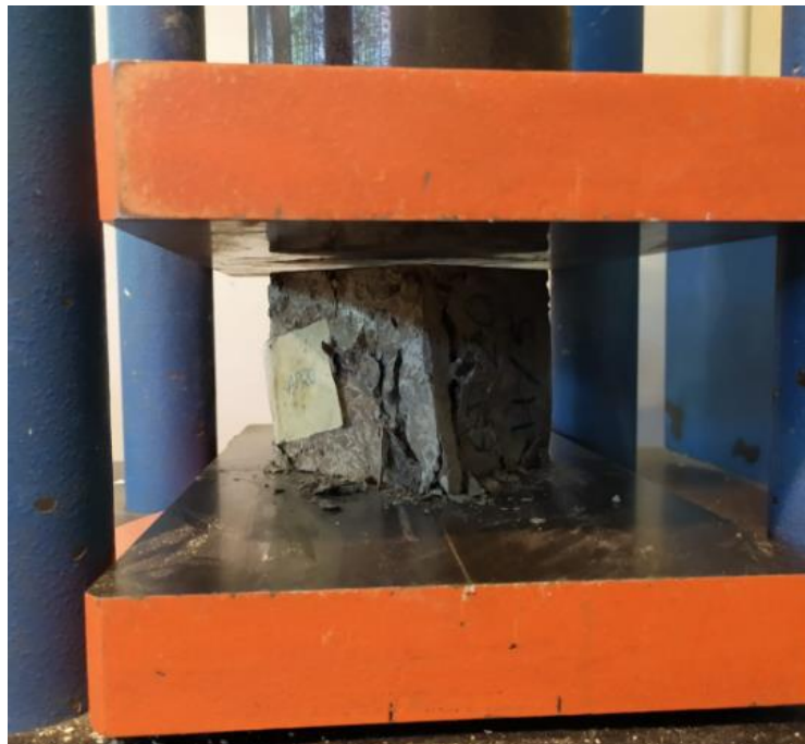
Figura 45. Probeta tras ensayo. Se observa el desprendimiento de las paredes laterales de la probeta cúbica propias de un ensayo correctamente realizado.
