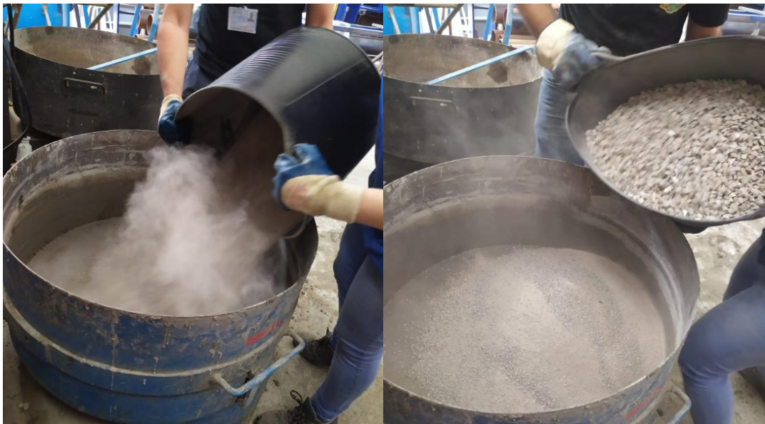
Figura 28. Izquierda: vertido de arena. Derecha: vertido de grava porcelánica.
