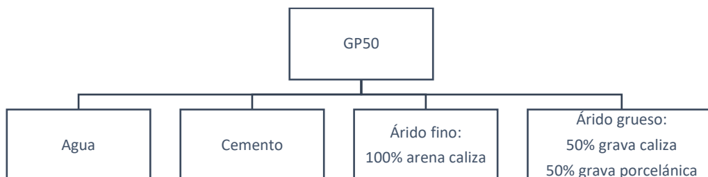
Figura 23. Composición del hormigón GP50.
