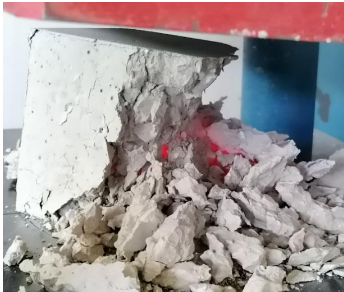
Figura 83. Desintegración de la probeta de hormigón GP50 en el ensayo de 800°C.
