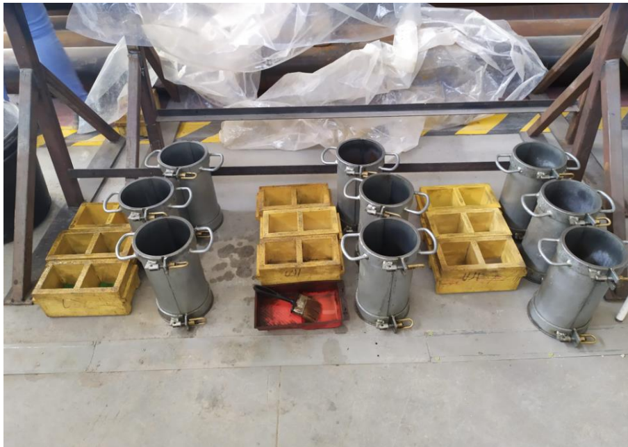
Figura 38. Moldes preparados y bañados en desencofrante (paleta y brocha) para tres amasadas diferentes.
