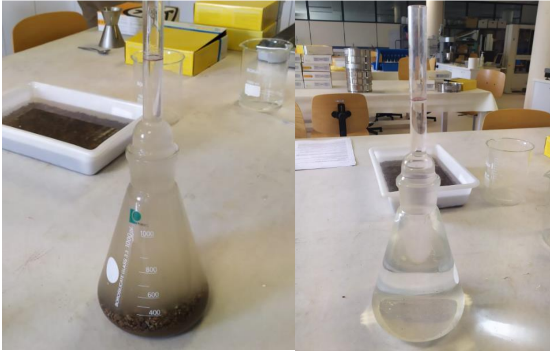
Figura 13. Izquierda: picnómetro con arena enrasado con agua para su pesado. Derecha: picnómetro lleno de agua para ser pesado.
