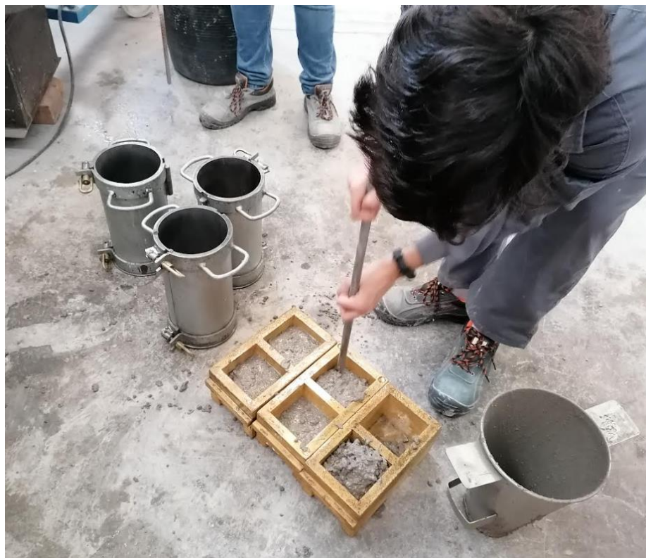
Figura 36. Rellenado de moldes y picado de probetas.
