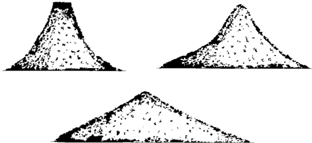
Figura 17. Norma UNE-EN 1097-6. Izquierda superior: árido húmedo, casi mantiene la forma completa del molde metálico. Derecha superior: árido ligeramente húmedo, se observa depresión apreciable. Inferior: árido saturado superficialmente secado, casi completamente colapsado, pero con un pico definido todavía visible y pendientes angulares.
