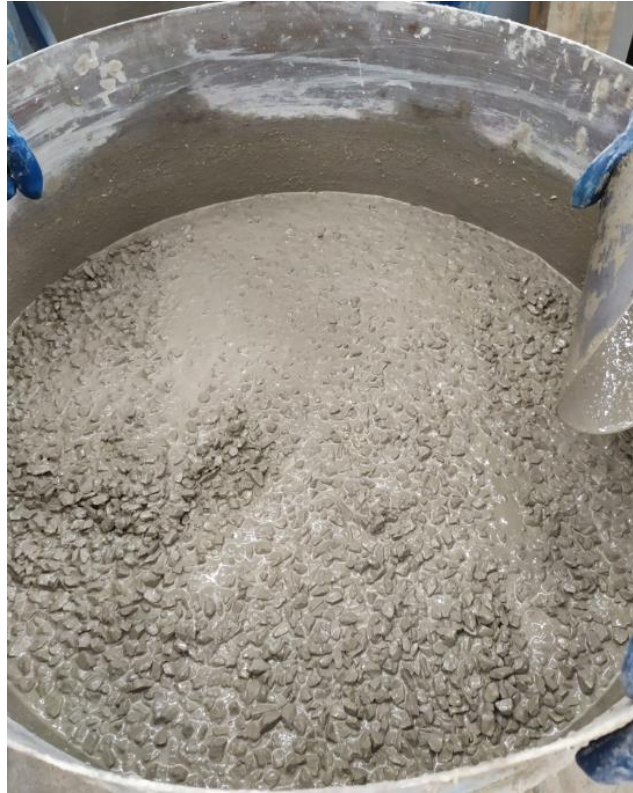
Figura 61. Segregación del hormigón GP100.
