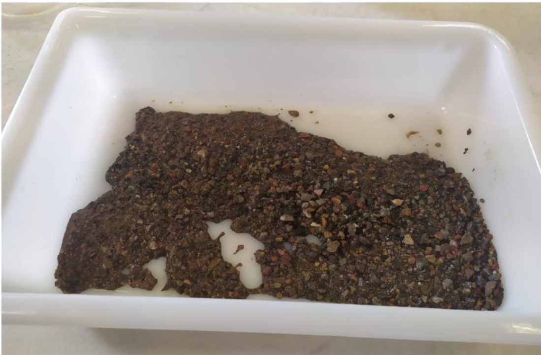
Figura 14. Arena húmeda lista para ser secada con corriente de aire caliente.
