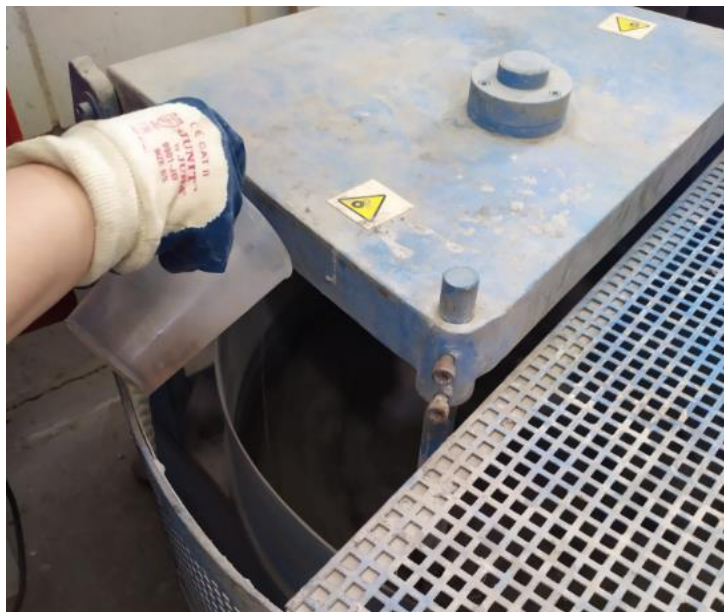
Figura 32. Vertido de fluidificante.
