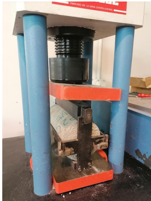
Figura 46. Colocación de los platos sobre el sistema de ensayo de tracción indirecta.
