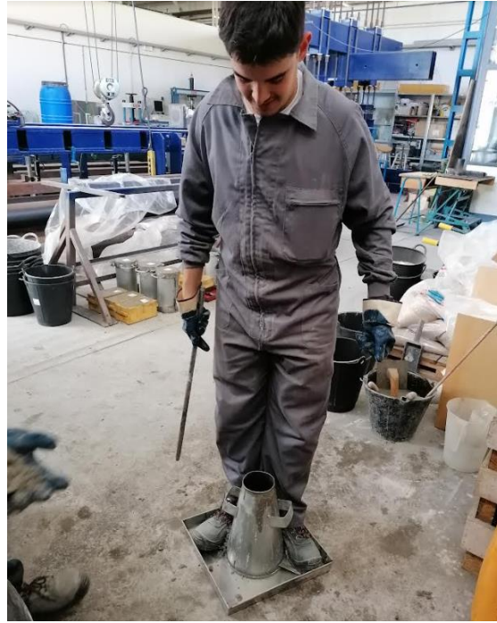
Figura 42. Procedimiento del ensayo de asentamiento. Sujeción del cono sobre bandeja metálica mientras se introduce el hormigón y se pica con la barra de compactación.
