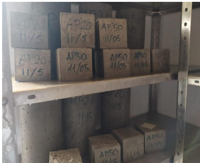
Figura 40. Depósito de las probetas del hormigón AP20 y AP50 en el interior de la cámara humidificadora.
