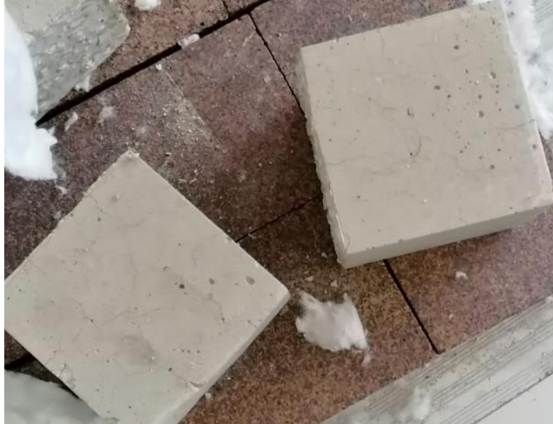
Figura 84. Cambio de color de las probetas cúbicas de GP50 a 800°C.
