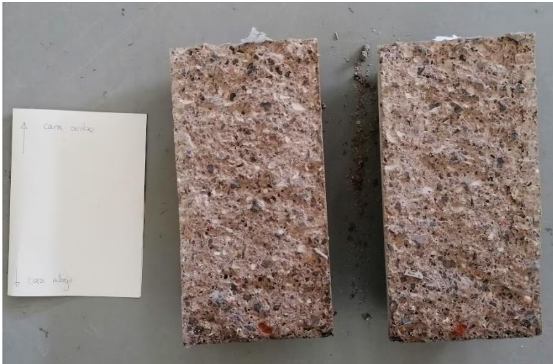
Figura 76. Ensayo de resistencia a tracción indirecta del hormigón REF.
