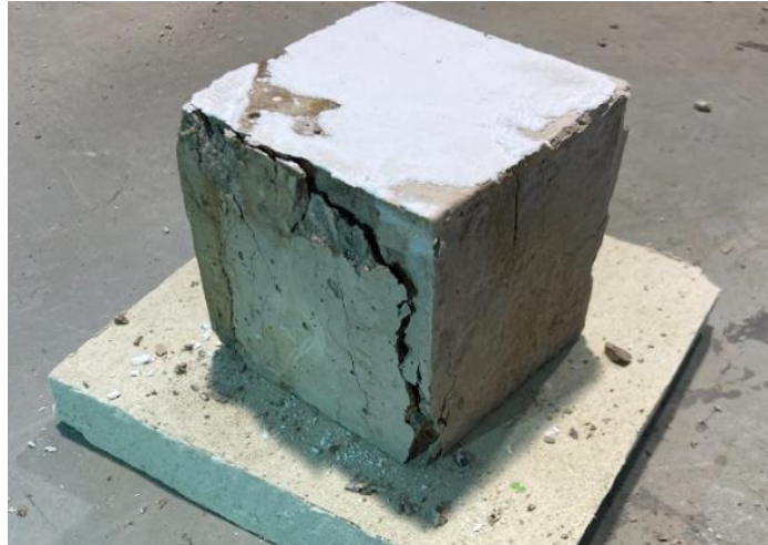
Figura 82. Spalling en la probeta de hormigón REF en el ensayo de 200°C.
