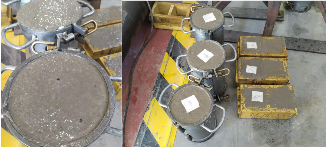
Figura 37. Moldes rellenos. Izquierda: detalle de aire retenido en el interior de uno de los moldes cilíndricos. Cabe recalcar la importancia de imprimir golpes suaves a los moldes para que expulsen el aire. Derecha: partida de moldes de una amasada (3 probetas cilíndricas y 6 cúbicas).
