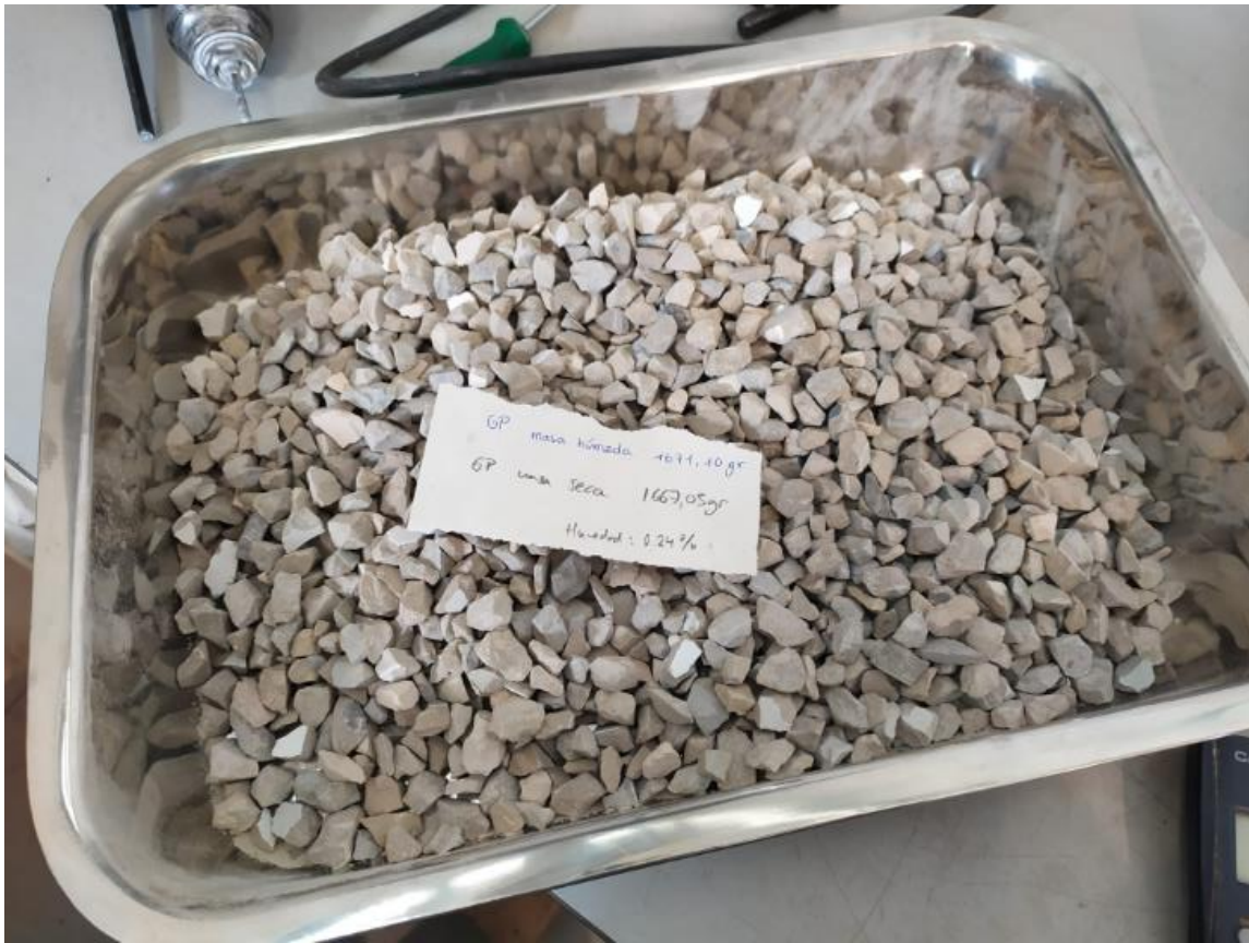
Figura 20. Muestra de grava porcelánica tras su segundo pesaje. Se observa en la nota escrita el peso del primer y segundo pesaje, así como del valor de la humedad resultante.
