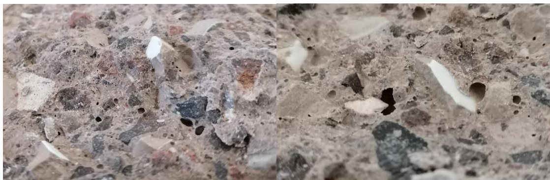
Figura 77. GP20. Detalle de la porosidad existente en la probeta del hormigón GP20. Detalle de la superficie esmaltada junto a los poros presentes en la probeta GP20.
