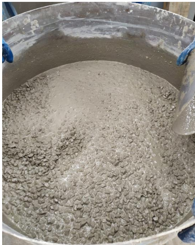
Figura 34. Hormigón previo a realizar el primer ensayo de asentamiento.
