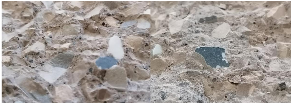
Figura 79. GP100. Detalle de porosidad y superficie esmaltada de color blanco y negro en el hormigón GP100, por provenir la grava porcelánica de diferentes productos de la industria cerámica (diferentes tipos de esmalte).
