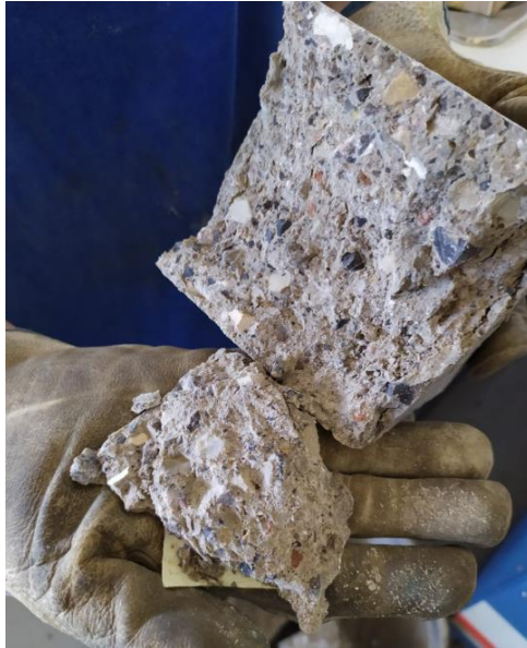
Figura 66. Rotura de una probeta cúbica GP20 en el ensayo de resistencia a compresión.
