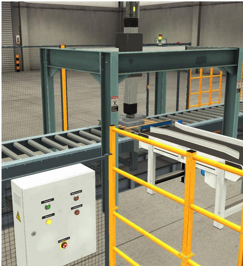
Figura 74: Emergencia en Paletizador M. Proceso parado y luces de advertencia
