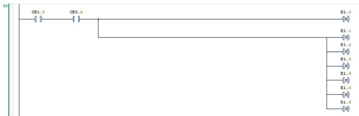
Figura 38: Desactivación Etapa 0 del Grafcet 1 y activación de las etapas 1 – 6
