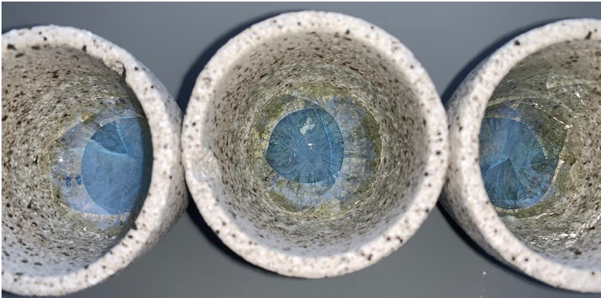
Figura 7.5. Ensayo de temperatura de fusión de la composición a 1400 °C.
