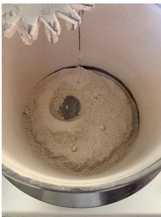
Figura 7.2. Ensayo de granulación. Imagen detallada del interior de la cuba al finalizar el ensayo. Se observa la capa de material pulverulento adherido a las paredes no granulado.
