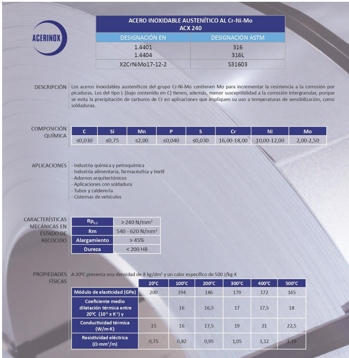
Figura A. 9.6. Ficha técnica acero inoxidable AISI 316 para la cámara de enfriamiento del horno de fusión vertical.
