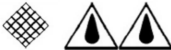
Fig. 4.1. Símbolos para la protección contra contactos directos IP65
