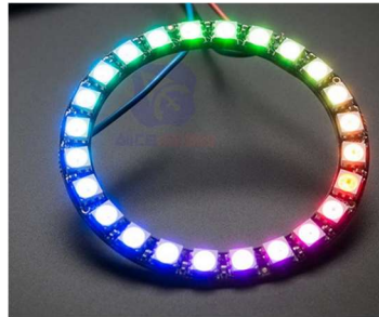
Figura 1.12: El nombre del producto es Diymore-Anillo de luz LED WS2812 5050 RGB y se adquiere al proveedor Alice1101983
