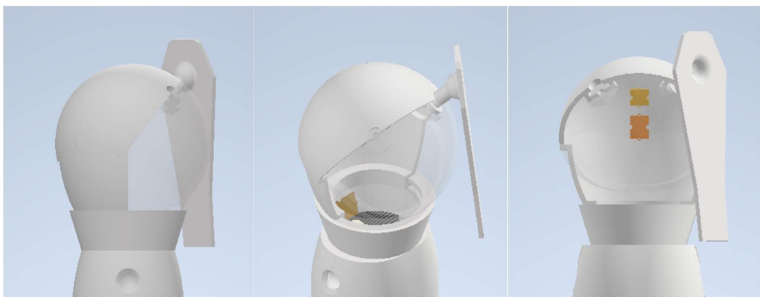
Figura 1.24: Imagen de detalle del conjunto del torso y cabeza; con la pieza tapa de la cabeza mostrada en transparente y algunos componentes internos. La pieza base de la coleta está insertada en el orificio entre las dos piezas de la cabeza.
