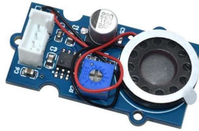
Figura 1.9: Su nombre es Altavoz+amplificador Grove y se adquiere al proveedor Seeed Studio.
