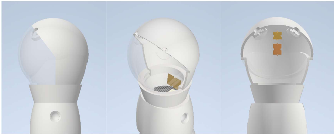
Figura 1.23: Imagen de detalle del conjunto del torso y cabeza; con la pieza tapa de la cabeza mostrada en transparente y algunos componentes internos.
