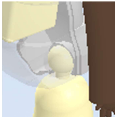
Figura 1.30: en la imagen se observa la unión en bola de la pierna con las dos carcasas del torso y como queda en conjunto con el resto de los elementos.
