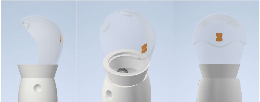
Figura 1.21: Imagen de detalle del conjunto del torso y cabeza; con la pieza cara y cabeza mostrada en transparente y algunos componentes internos.
