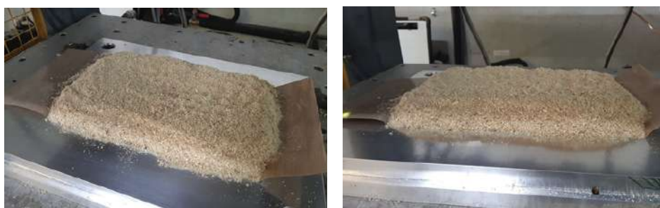
Imagen 100. Vertido de la mezcla F(5%) para la termocompresión
