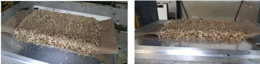
Imagen 104. Vertido de la mezcla F(15%) para la termocompresión
