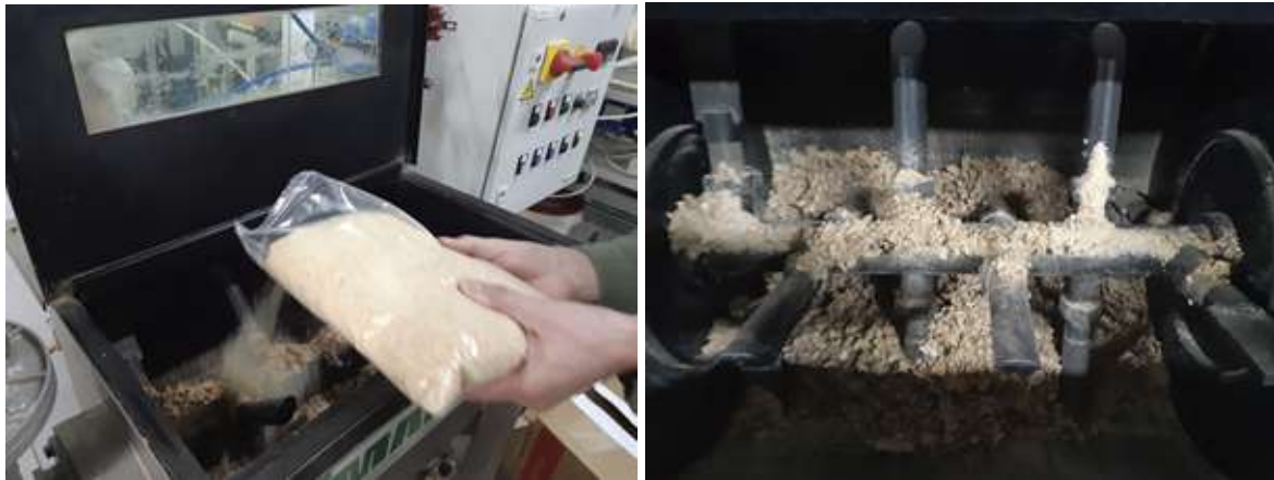
Imagen 97. Residuos en el interior del tanque de la encoladora
