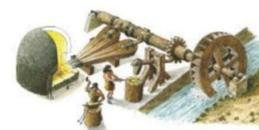
Fig 1: Fuego hidráulica. La fuerza del agua mueve el martillo, facilitando la labor para elaborar todo tipo de herramienta.
