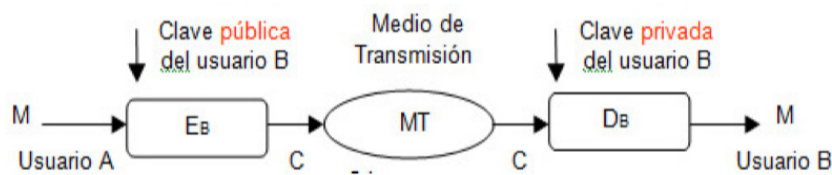
Figura 2. Esquema del criptosistema de cifrado con clave pública y descifrado con clave privada.
