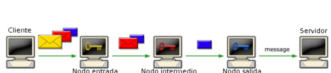
Figura 4. Estructura del cifrado de la red TOR.
