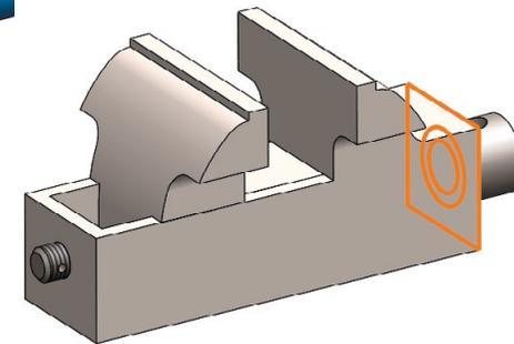
✓ Añada un emparejamiento mecánico (tipo *tornillo*) para simular el desplazamiento de la mordaza móvil al girar el tornillo sinfín
