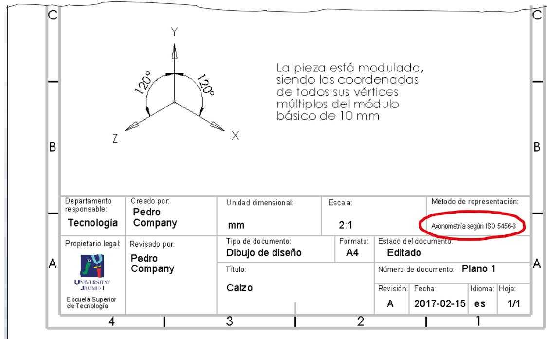
La pieza está modulada, siendo las coordenadas de todos sus vértices múltiplos del módulo básico de 10 mm
