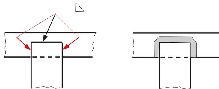
Para indicar uniones que requieren más de un tipo de soldadura...
