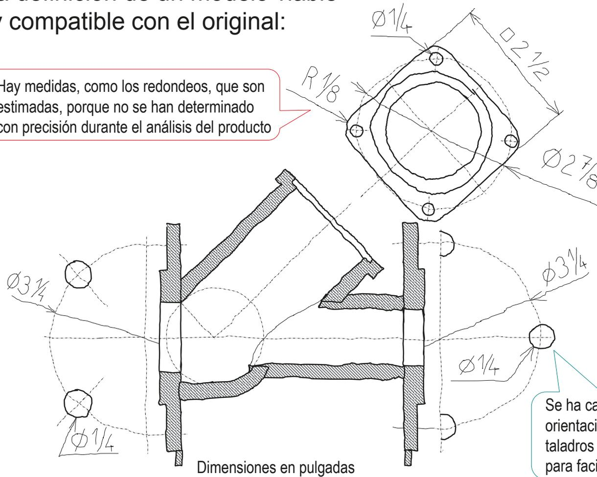
Se ha cambiado la orientación de los taladros originales, para facilitar el montaje
