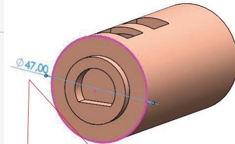
Esta cota ya está presente en el modelo, pero ahora se añade como una anotación de intención de diseño, mediante una "copia" que no es cota conductora, sino conducida
