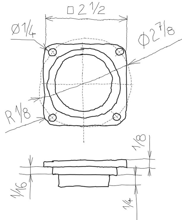
Diseñe una junta tórica que encaje en el hueco entre el tubo y la tapa
