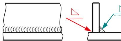
La colocación relativa entre la flecha y la junta tiene significado:
