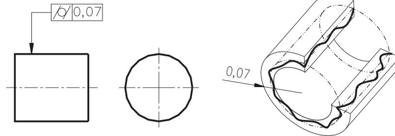
La cilindridad es una tolerancia compuesta:
