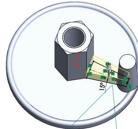
Haga que el perfil se intersecte con el ala para obtener automáticamente la intersección de los sólidos
