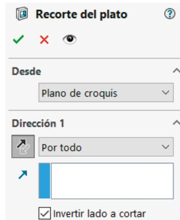
Marque la opción de *Invertir lado a cortar*, para que se elimine la parte del plato que queda fuera del cilindro
