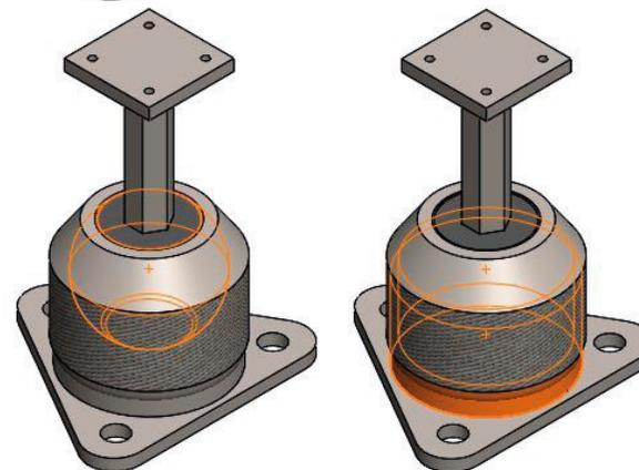
✓ Añada los emparejamientos para simular el roscado del anillo de fijación en el soporte
