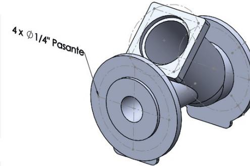
✓ Repita el procedimiento para anotar los taladros de la brida cuadrada del tubo inclinado
