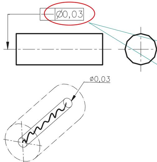
El símbolo de “diámetro” ( $\varnothing$ ) indica que el eje del cilindro deberá estar contenido en una zona de tolerancia cilíndrica de diámetro el valor de la tolerancia y eje coincidente con la recta que se controla
