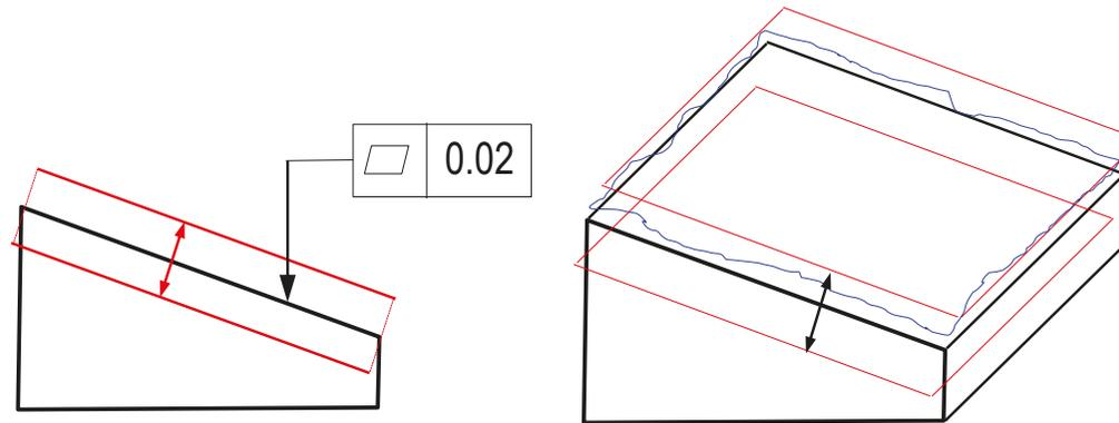
Para definir una dirección distinta, se debe acotar la dirección elegida, mediante una cota a la flecha de referencia
