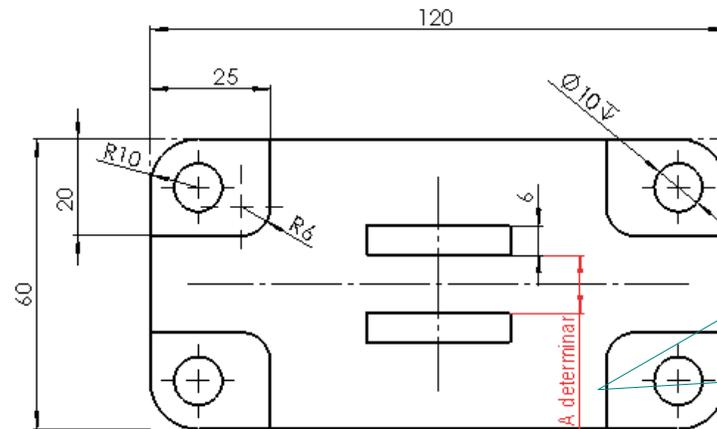
Debe observarse que la separación entre aletas de la base debe tener la medida suficiente para que quepan la oreja del soporte y las dos arandelas
