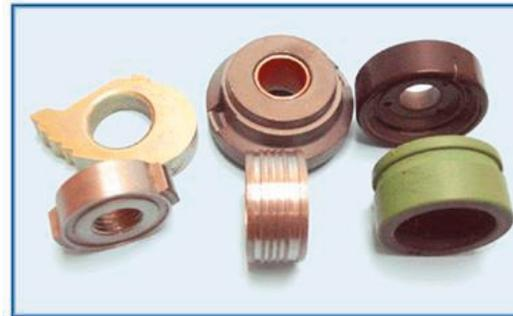
En el **sinterizado** los materiales se muelen en polvo muy fino, se mezclan para conseguir las propiedades deseadas, luego se compacta la mezcla para darle la forma deseada y, por último, se somete a grandes presiones o campos eléctricos para que solidifique y adquiera la máxima resistencia mecánica
