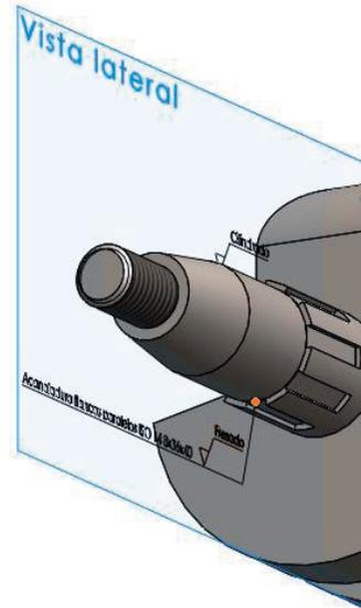
La anotación que no está vinculada mediante flecha al modelo, se coloca manualmente a la profundidad del plano de anotación (plano derecho)
