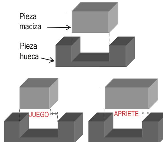
Especificar un ajuste es asignar tolerancias a las medidas de ambas piezas para asegurar el comportamiento esperado del ensamblaje
