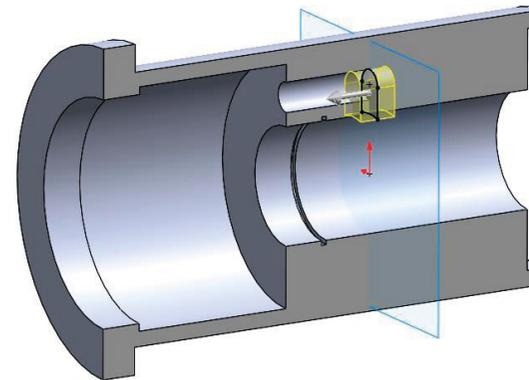
✓ Obtenga el resto de cilindros y lumbreras mediante un patrón de repetición
