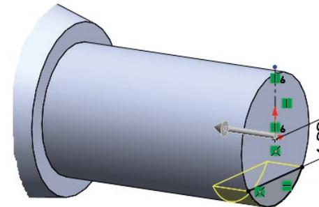
✓ Utilice un corte extruido con desplazamiento, desde la planta, para obtener el chavetero
