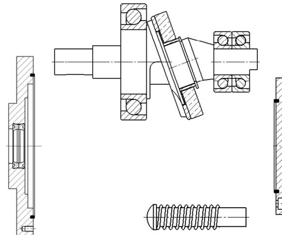
El muelle se modela con la longitud de precomprimido, y se ensambla como rígido, sin simular la compresión
