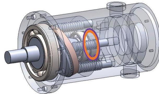
√ Opcionalmente, encaje el rodamiento angular exterior en la boca de la carcasa
