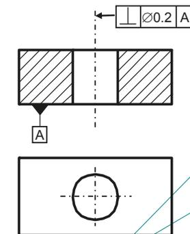
El diámetro del cilindro coincide con el valor de la tolerancia y su eje es perpendicular al plano de referencia
