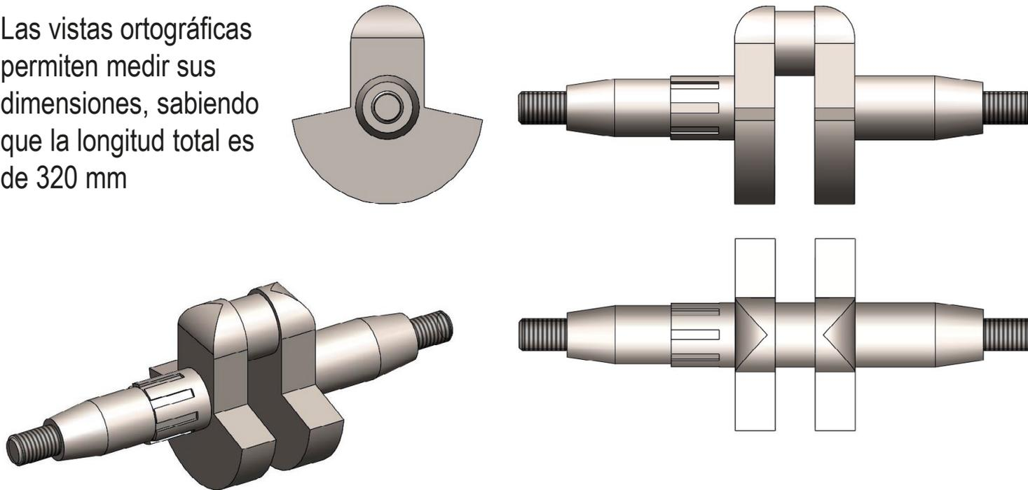
Para completar la definición, se debe tener en cuenta que los tramos cilíndricos de los extremos están roscados con rosca de tipo métrico, y el ranurado es cilíndrico de caras paralelas según ISO 14
