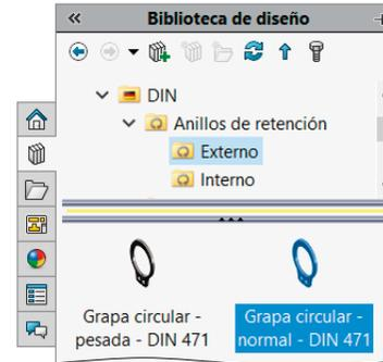
✓ Haga concéntricos la cara interior del anillo y la ranura de  $\varnothing 33$  del tramo inclinado del árbol
