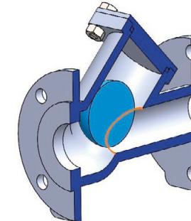
✓ Utilice una nota apuntando al extremo superior del tubo inclinado para indicar que la bola es empujada hasta esa parte por el líquido entrante
