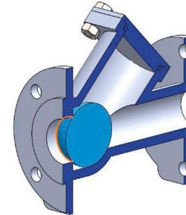
✓ Utilice una nota apuntando a la intersección entre conductos para indicar que la bola rueda por el tubo inclinado sin encajarse en el tubo horizontal, porque el segundo tiene menor diámetro
