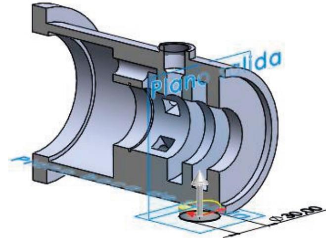
✓ Utilice la boca de salida para añadir un taladro parcialmente roscado, y alineado con el eje auxiliar
