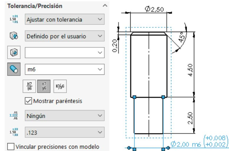
√ Una tolerancia H7 para la cota del agujero de  $\varnothing 2$  de la barra
