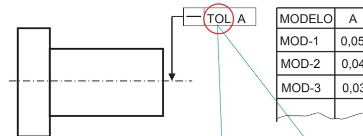
La letra que indica el parámetro puede ir precedida del prefijo "TOL", para evitar que se confunda con la indicación de un elemento de referencia
