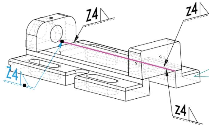
Cambiar el modo de visualización puede ayudar a seleccionar las juntas
