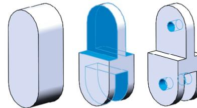
Alternativamente, use un croquis del perfil para obtener una forma prismática por extrusión, y redondeela después
