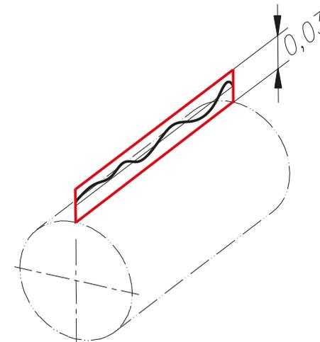
No se controlan las desviaciones que el elemento controlado pueda tener *fuera* del plano de control
