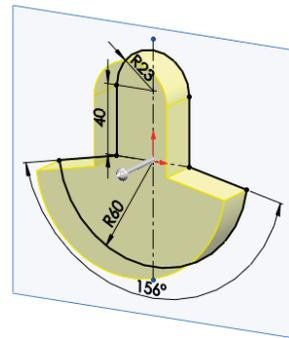
√ Extruya con *equidistancia*, para obtener el volante derecho
