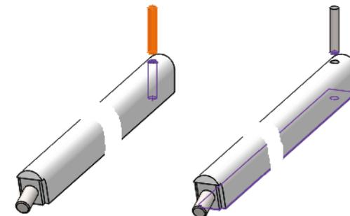
¡Para simular el proceso real de montaje, el tope se debería insertar *después* de encajar la aguja deslizante en la guía!
