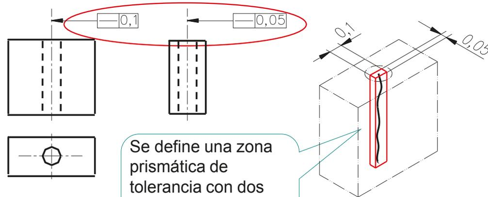
Se define una zona prismática de tolerancia con dos tolerancias ortogonales entre sí
