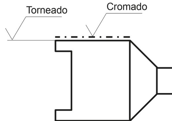
√ Alternativamente, la línea gruesa de trazo y punto sirve para indicar procesos de fabricación que afectan parcialmente a una superficie
