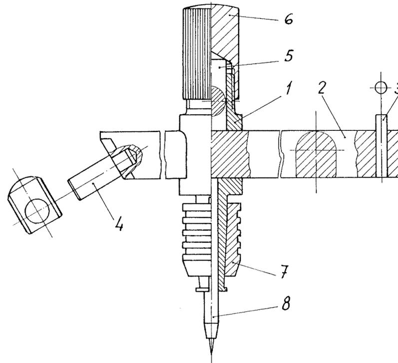
Se usa para adaptarla a un compás, a fin de aumentar el radio del círculo máximo que se puede trazar con él
