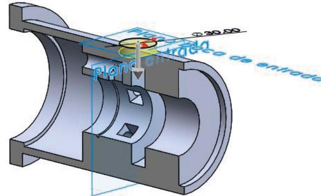
✓ Utilice la boca de entrada para añadir un taladro parcialmente roscado, y alineado con el eje auxiliar
