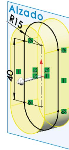
✓ Obtenga los escalones y la ranura por corte extruido a partir de un perfil dibujado en la vista lateral
