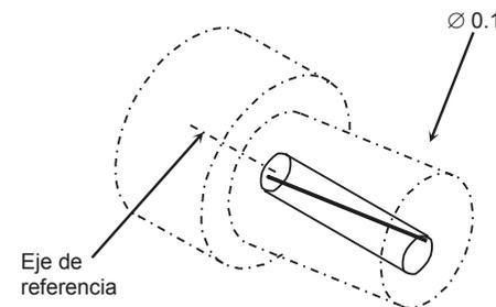
El eje de la zona cilíndrica de la izquierda debe estar contenido en un cilindro cuyo eje coincide con el del tramo cilíndrico derecho y tiene un diámetro de 0.1 mm
