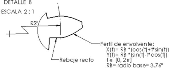
Ciertos tipos de **anotaciones normalizadas** pueden reemplazar representaciones geométricas, consiguiendo una reducción del tiempo de dibujo o modelado y una mejora en la eficiencia de la comunicación de la información del producto
