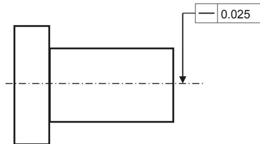
La dimensión de la zona de tolerancia se puede indicar por medio de un **parámetro**
