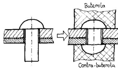
Una de las cabezas se conforma en el momento de la fabricación del remache, mientras que la otra, denominada cabeza de cierre, se conforma, o "recalca", en el momento de fijar la unión (presionando al roblón en sentido axial entre dos elementos, buterola y contra-buterola, que le dan forma)
