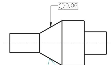
la 'zona de tolerancia' se extiende siempre dentro del plano que produce secciones redondas
