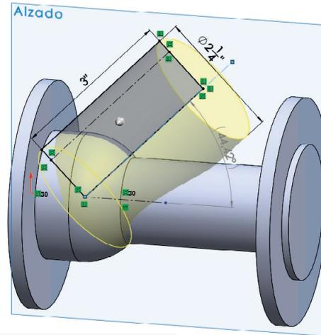
✓ Obtenga la brida cuadrada del tubo inclinado por extrusión
