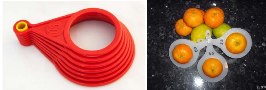
Imágenes 4 y 5. Calibrador manual general y calibrador usado en clemenules: se utilizan de igual manera con menores valores de diámetro permitido para el segundo caso.
