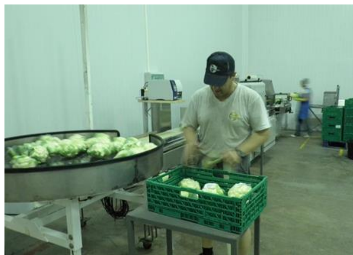
Ilustración 15. Encajado manual de piezas filmadas (Fuente: Departamento de producción)
