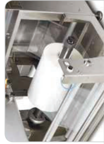
Portabobinas de carga frontal que facilita la carga de la bobina
