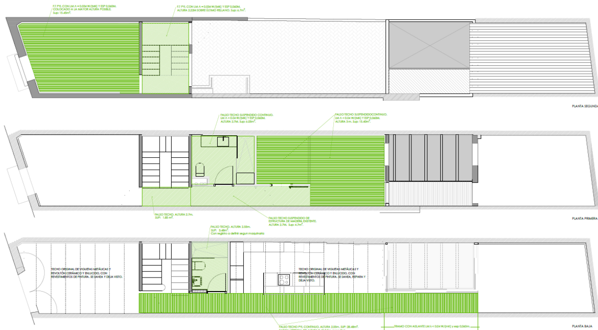
Imagen 115: Zonas grafiadas para aislamiento en falso techo.
