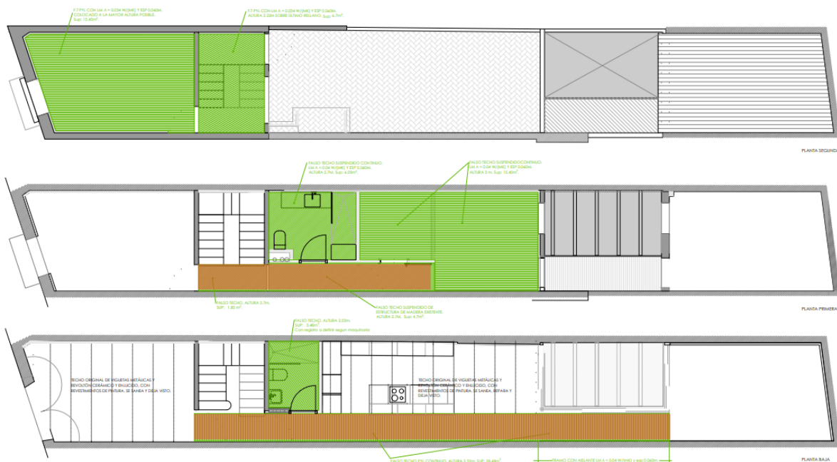
Imagen 116: Grafiado de los aislamientos eliminados en falso techo.
