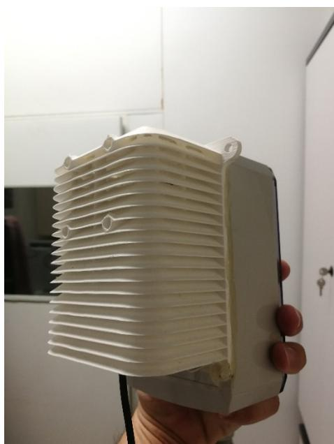
**Figura 1.** La impresión en 3D de la caja del sensor de PM
