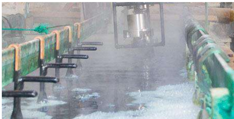
Figura 89. Acabado por baño electrolítico.
