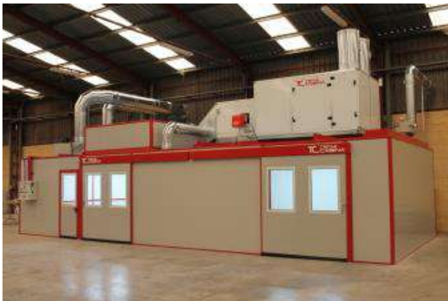
Figura 88. Cabina de pintura con aspiración y filtrado.
