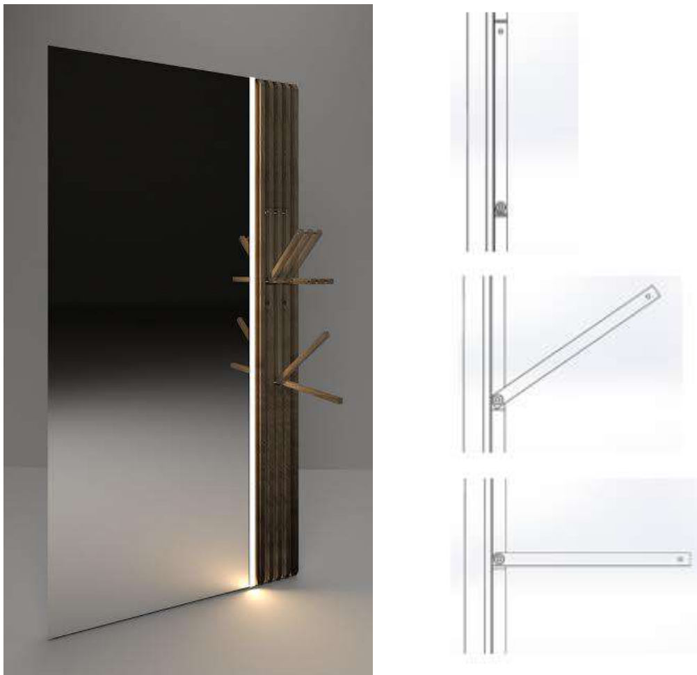
Figura 54. Detalle de los accesorios ocultos en las lamas del espejo Taglio.
