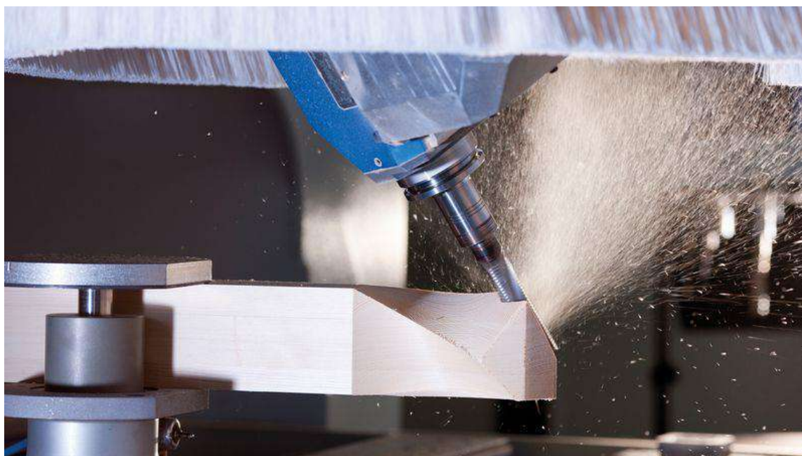
Figura 49. Mecanizado de las lamas por control numérico.
