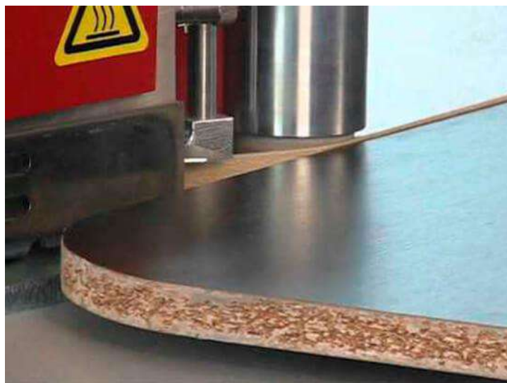
Figura 51. Canteado con melamina.
