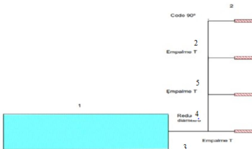
*Figura 3.1. Perfil desde la superficie del DAF a la entrada del fluido en las bombas.*
