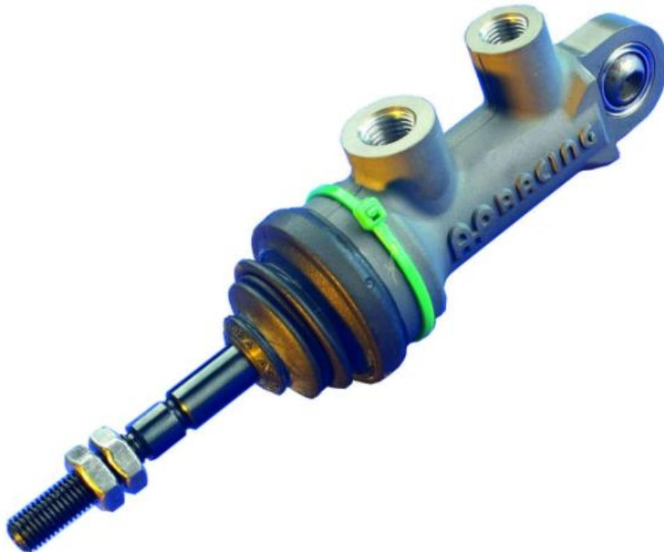
Ilustración 36: Bomba de freno AP Racing CP7855.
