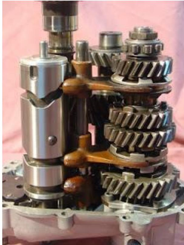
*Ilustración 6: Mecanismo y sincronizadores de una caja de cambios secuencial de motocicleta.*
