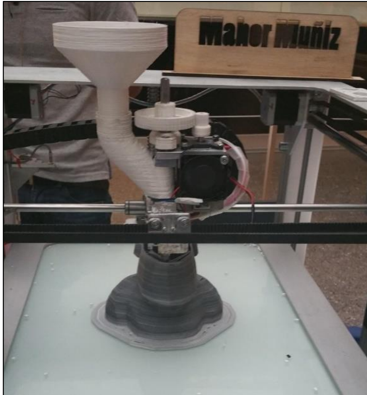
Ilustración 4. Extrusor con pellet acoplado a extrusor (IMPRIMALIA 3D, 2017)
