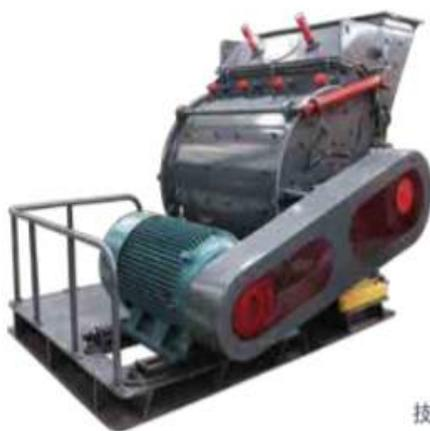
该机广泛应用于冶金、矿山、化工、水泥、建筑、耐火材料及陶瓷等工矿企业中，从事物料中碎和细碎作业。其主要适宜破碎抗压强度不高于320MPa（光轮）的各种矿石。
