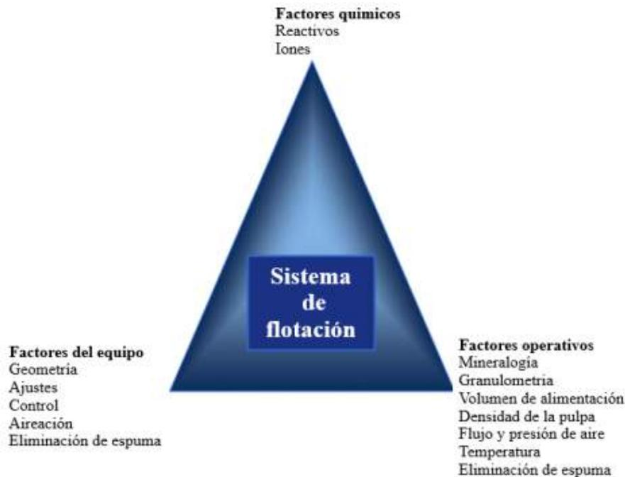
*Figura M.3.3.1.1 Ilustración de la flotación como un sistema interactivo de tres vértices (MAO, 1998 -modificado).*
