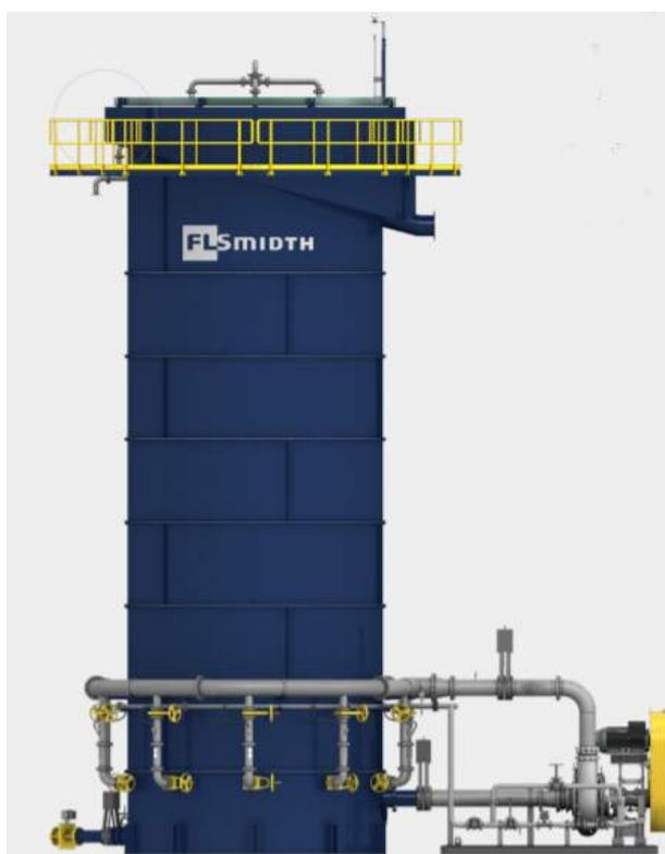
*Figura A.3.1.11.1. Columna de flotación.*
