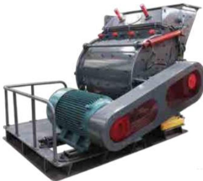
*Figura A.3.1.5.1 Triturador primario.*
