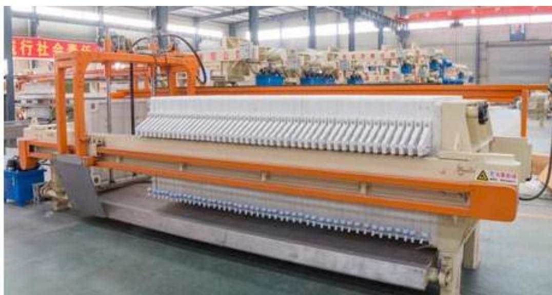
**Figura A.3.1.13.1** Filtro prensa similar al seleccionado para el proceso.
