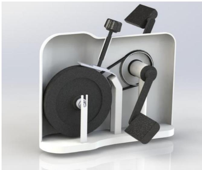
*Ilustración 28 Componentes de la pedalera*
