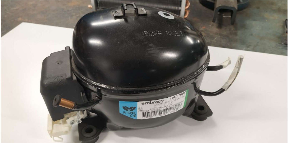
Figura 21. Compresor utilizado en el sistema.
