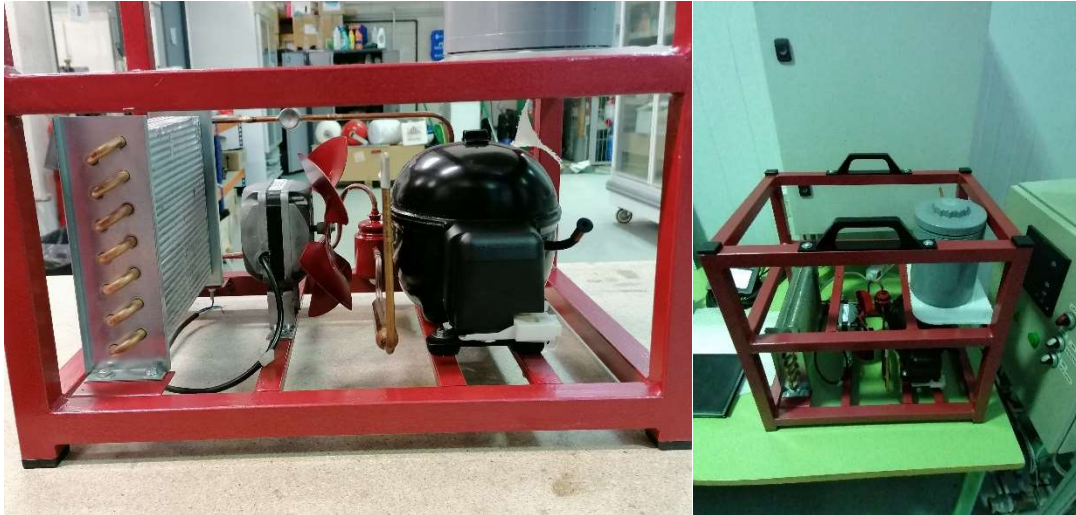
Figura 46. Circuito frigorífico montado.
