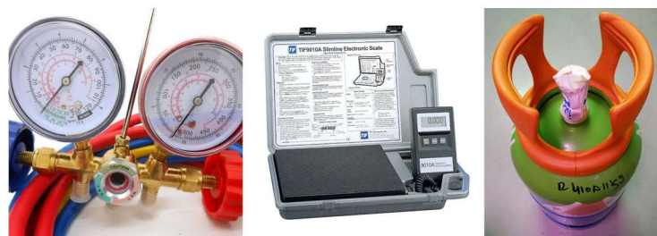
Figura 50. Equipo de carga de refrigerante.
