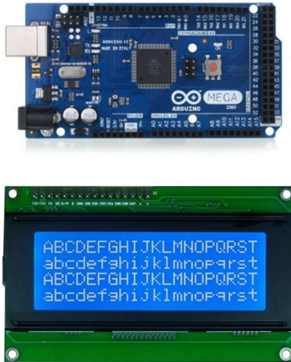
Figura 57. Placa MEGA2560 y display 20x4.
