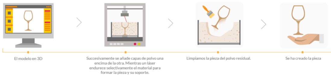
Figura 71. Proceso de fabricación mediante SLS
