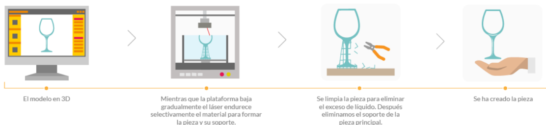
Figura 70. Proceso de fabricación mediante SLA
