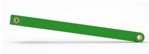
Figura 237. Modelo 3D Barra 3 dedo índice perfil
