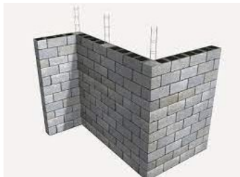
Fig. 17: Bloques de hormigón en cerramientos de fachada
