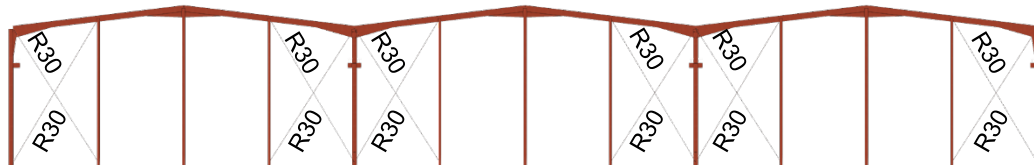
Fig. 8: Arriostramiento pórtico de fachada
