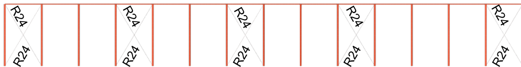
Fig. 9: Arriostramiento fachada lateral
