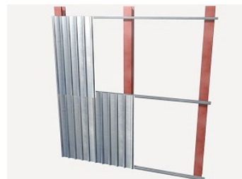
Fig. 18: Chapa en cerramientos de fachada
