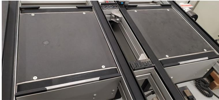
Figura 1.13: TS 2 plus - Dos estaciones de desviación adyacentes conectadas mediante 2 vías de rodillos
