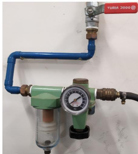
Figura 1.4: Sistema de filtrado y regulación de aire a presión del robot y su llave de paso
