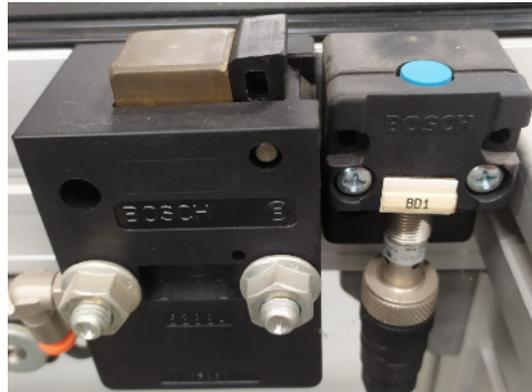
Figura 1.15: TS 2 plus - Separador de tramos (izquierda) con su detector de proximidad (derecha)
