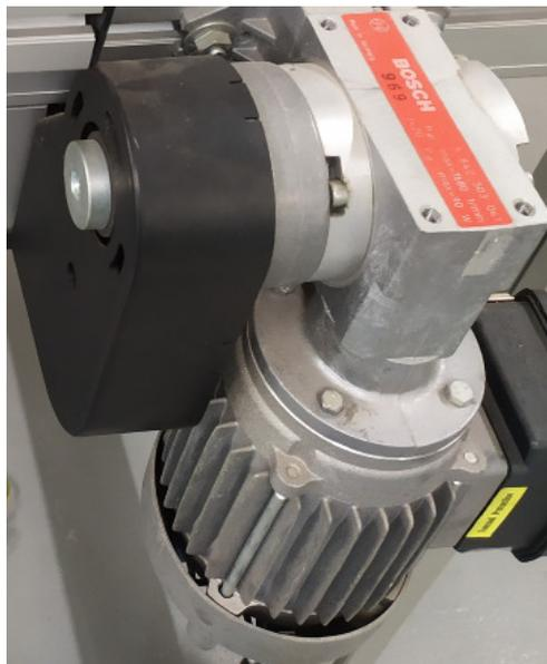
Figura 1.20: Motor reductor del sistema
