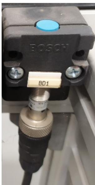
Figura 1.17: Detector inductivo de proximidad del sistema
