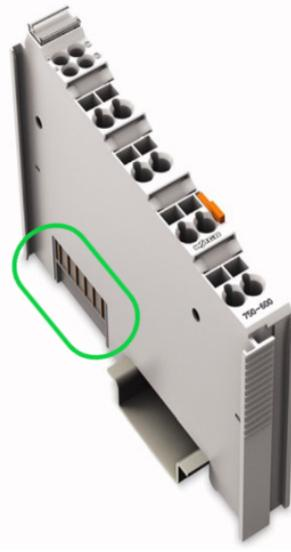
Figura 1.27: Apariencia del módulo final Wago 750-600 (conectores laterales en verde)
