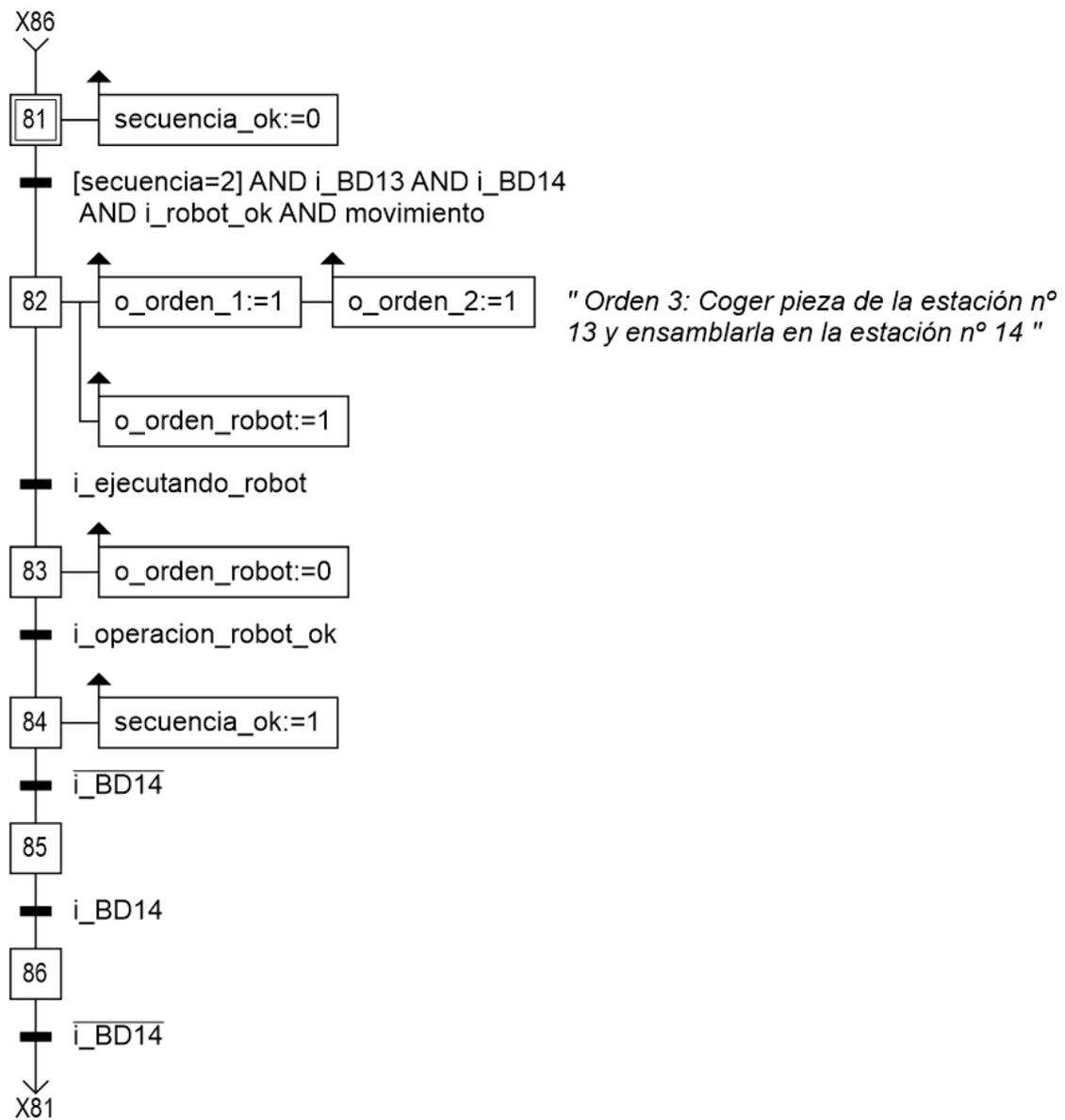
Figura 5.17: Diagrama de funcionamiento del robot (G24)
