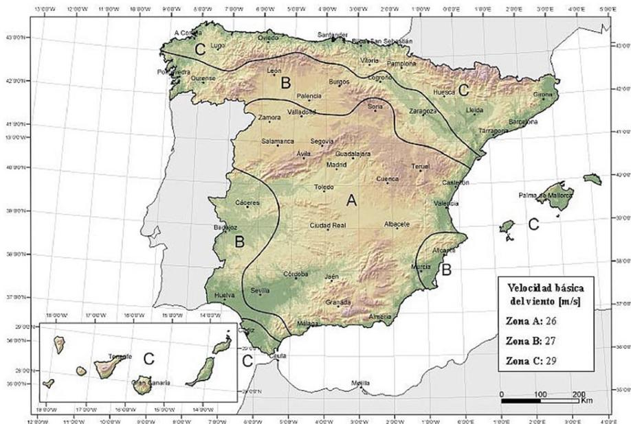
Ilustración 36 - Mapa de isotacas para la obtención de la velocidad básica fundamental del viento  $v_{b,0}$
