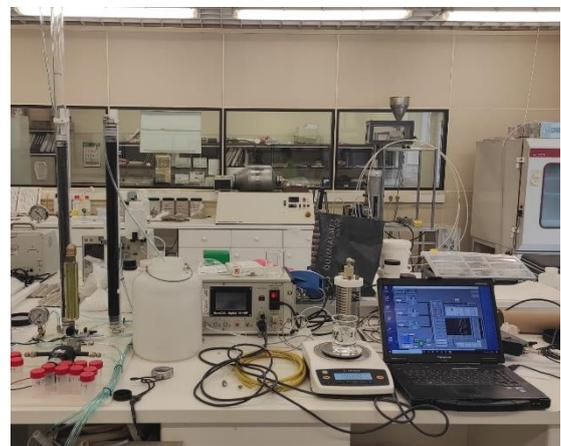
Figura 76: Montaje del dispositivo experimental de laboratorio de la columna de adsorción.
