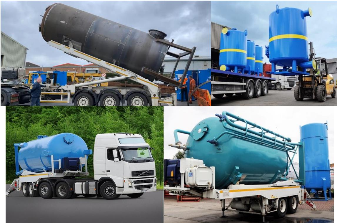
*Figura 63: Operaciones de recambio de columna de lecho fijo rellena de carbón activo.*
