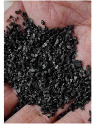
Figura 75: Fotografía del carbón activo MG1050 12x40 de ChemiVall.
