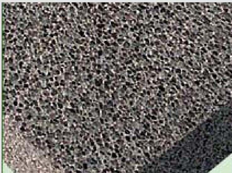
Figura 4.9.- Paneles de vidrio celular. Fuente: Vidrioweb.me.
