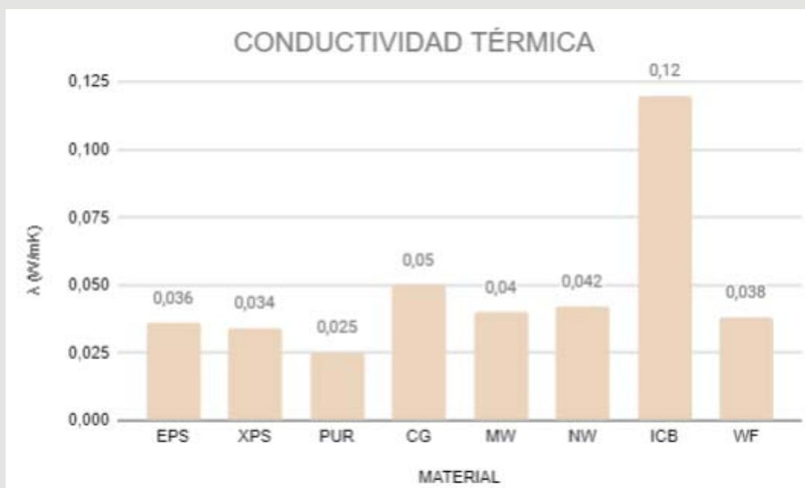
Figura 4.16.-Gráfico comparativo de la conductividad de los materiales aislantes.
