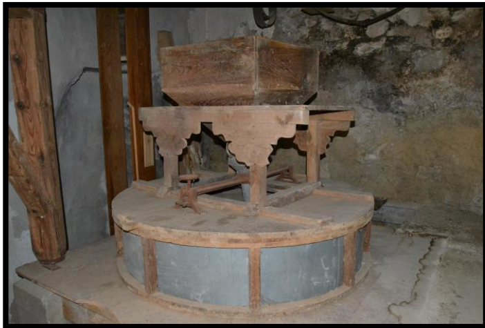
Figura 4.18. Mola gran accionada amb motor de vapor. (Font: Autor.)
