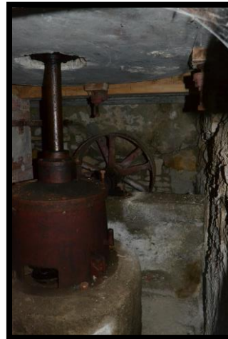
Figura 4.19. Eix inferior de la mola a motor i la corriola que li transmet el moviment. (Font: Autor.)
