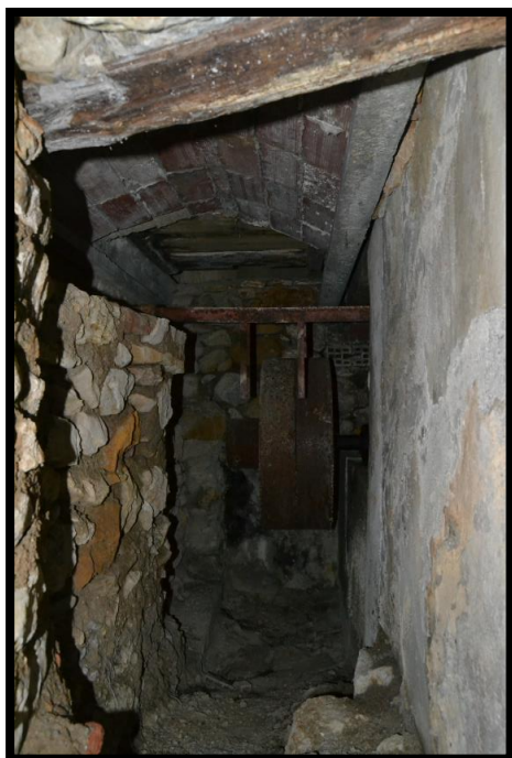
Figura 4.34. Galeria que uneix el motor de gasoil amb la mola. (Font: Autor.)
