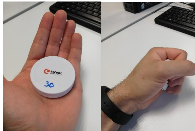
Figura 8.6: Baliza fuera de la mano y en la mano para interferir en la señal que emite. 32
