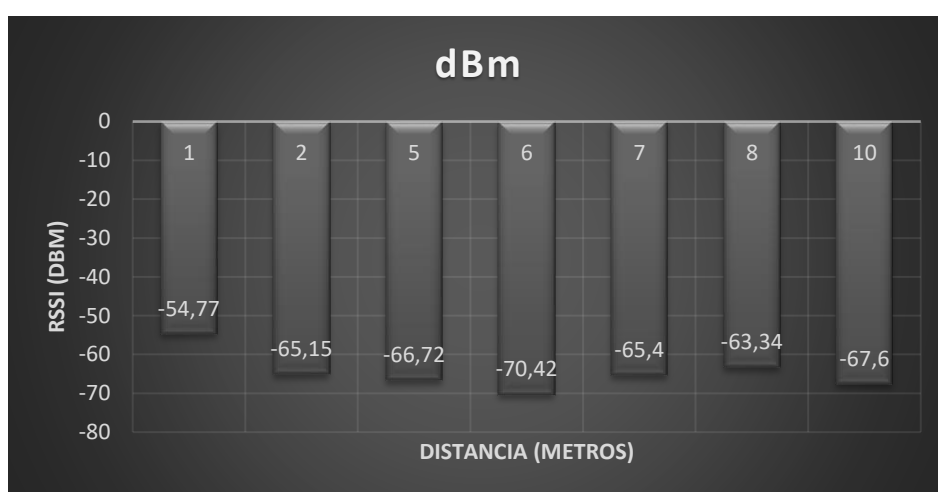
Figura 8.3: Resultados en forma de gráfico de barras de las mediciones de la tabla 8.1 para encontrar la distancia máxima a la que los sensores pueden captar la señal de la baliza.
