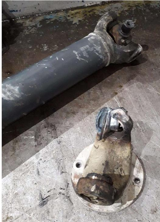
*Ilustración 27: Cardán del sistema de transmisión rota*
