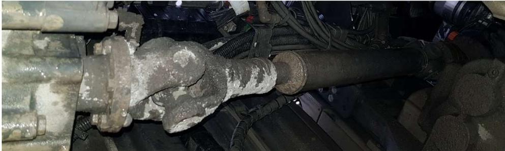
*Ilustración 25: Sistema de transmisión por cardán*
