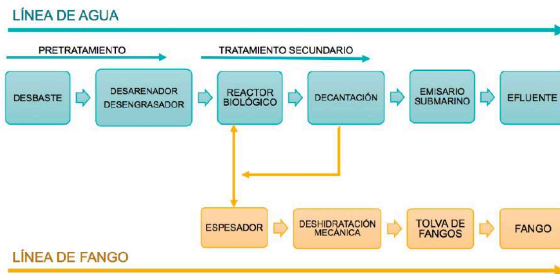
Figura M.1. Diagrama de proceso de la EDAR de Oropesa.
