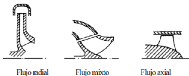
Figura M.30: Dirección de entrada y salida del flujo según el tipo de bomba
