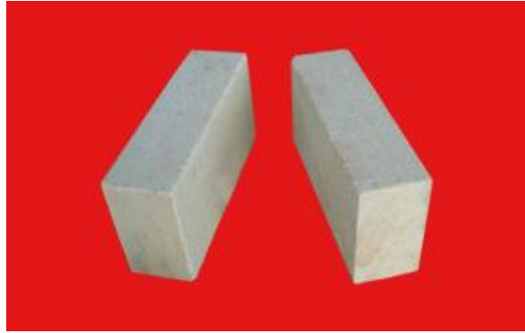
Figura M.4: Ladrillo de mullita, contenido en alúmina aproximadamente del 70%
