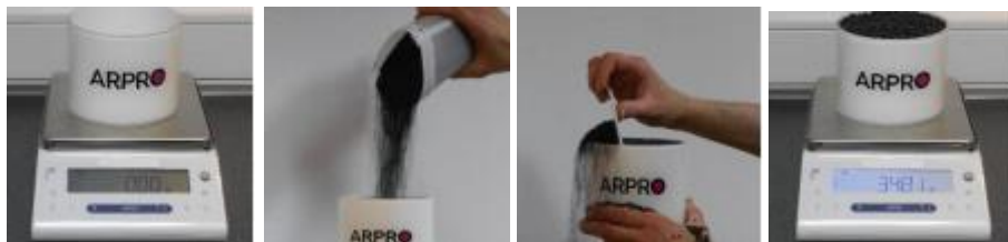
Figura M.20: Método del cilindro para estimar la densidad aparente
