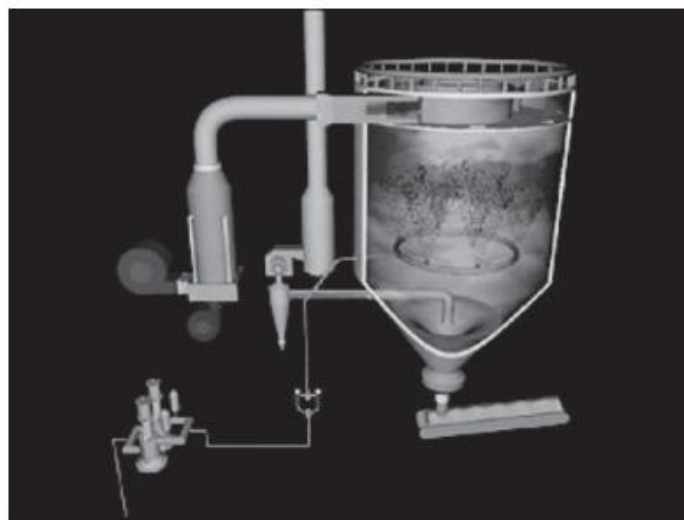
Figura M.45: Funcionamiento de atomizador de corrientes mixtas, nebulizador de corona, con aire descendiente
