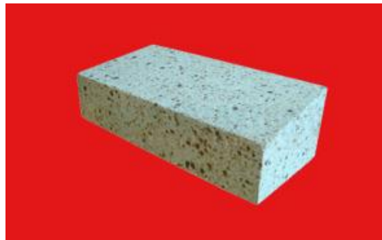
Figura M.3: Ladrillo de sillimanita, contenido en alúmina superior al 60%
