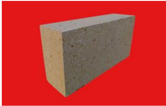
Figura M.2: Ladrillo de sillimanita, contenido en alúmina superior al 50%
