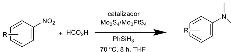
**Figura 13.** N-metilación directa de nitroarenos empleando ácido fórmico. Elaboración propia.
