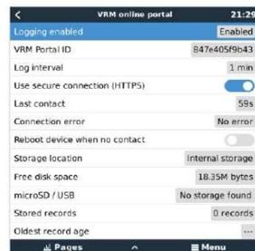
La transmisión del registro de datos está diseñada para funcionar incluso si la conexión a Internet no es buena. Las líneas con hasta un 70 % de pérdida de paquetes permanente son suficientes para que los datos salgan, aunque se retrasen en algunos casos.
