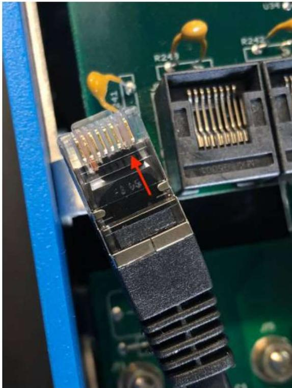
El inconveniente de cortar el pin 7 es que apagar el dispositivo VE.Bus será menos eficaz: aunque dejará de cargar e invertir, seguirá en modo reposo y por lo tanto extraerá más corriente de la batería que si se hubiera dejado el pin 7. Normalmente, esto solo es relevante en sistemas marino o de automoción, en los que es habitual apagar el dispositivo VE.Bus regularmente. En estos sistemas, le recomendamos que no corte el pin 7 y que simplemente alimente el CCGX desde la batería.
