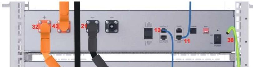
(3) Pulse el botón de inicio de la batería principal para encenderla. Todas las baterías del grupo se irán encendiendo progresivamente, empezando por la batería principal.
