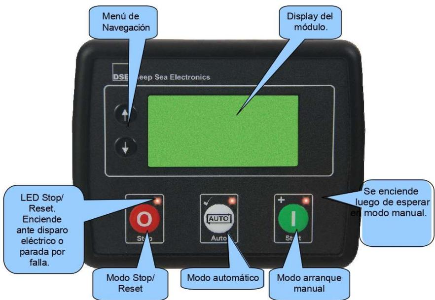
**PRECAUCIÓN:** El módulo puede arrancar el motor debido a influencias externas, por lo tanto es posible que se inicie en cualquier momento. Antes de realizar cualquier tarea de mantenimiento en el sistema, remover la batería y conexiones aisladas.
