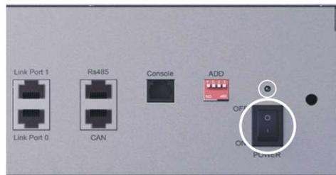
NOTA. Recuerde que la batería con el puerto de enlace 0 vacío es la batería principal
