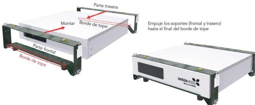
Empuje los soportes (frontal y trasero) hasta el final del borde de tope
