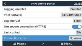
Si aparece un error de conexión, el CCGX no puede entrar en contacto con la base de datos de VRM. El error de conexión mostrará un código de error que indica la naturaleza del problema de conectividad. Además, se mostrarán los detalles del mensaje de error para que los expertos locales de TI puedan diagnosticar el problema.
