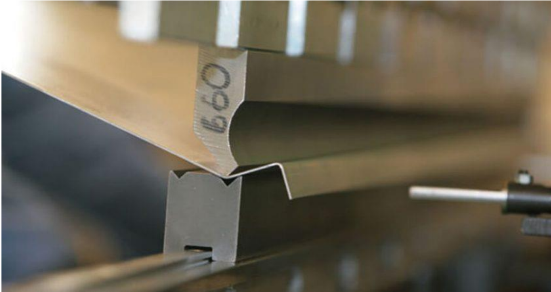
Figura 45. Proceso de plegado de chapa.
