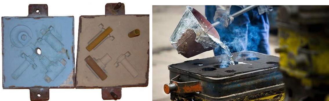
Figura 48. Moldeo en arena.
