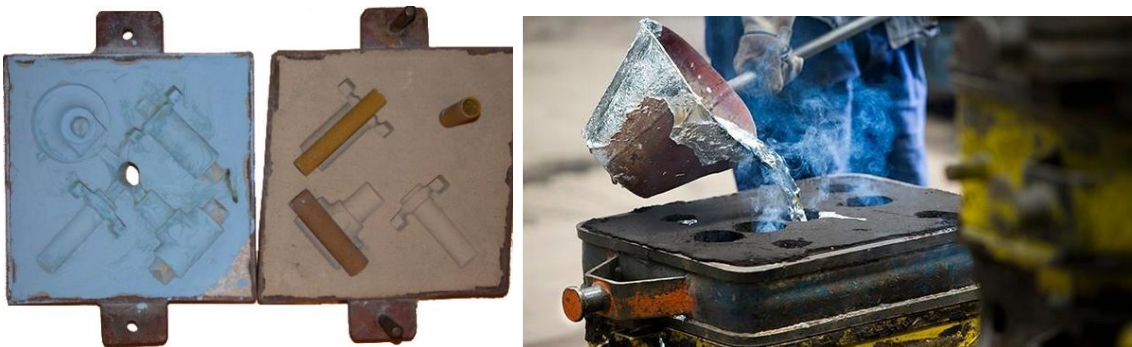
Figura 57. Moldeo en arena
