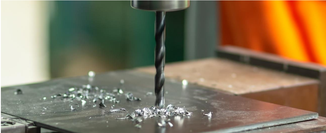
Figura 147. Proceso de taladrado
