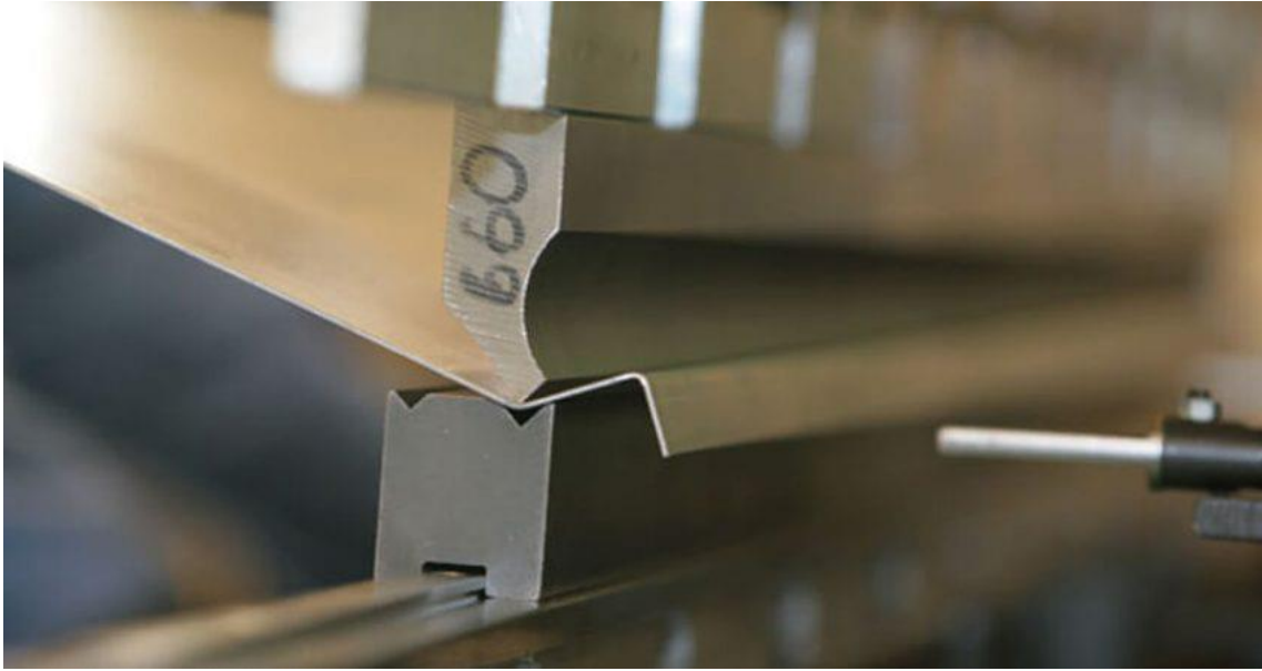
Figura 54. Proceso de plegado de chapa
