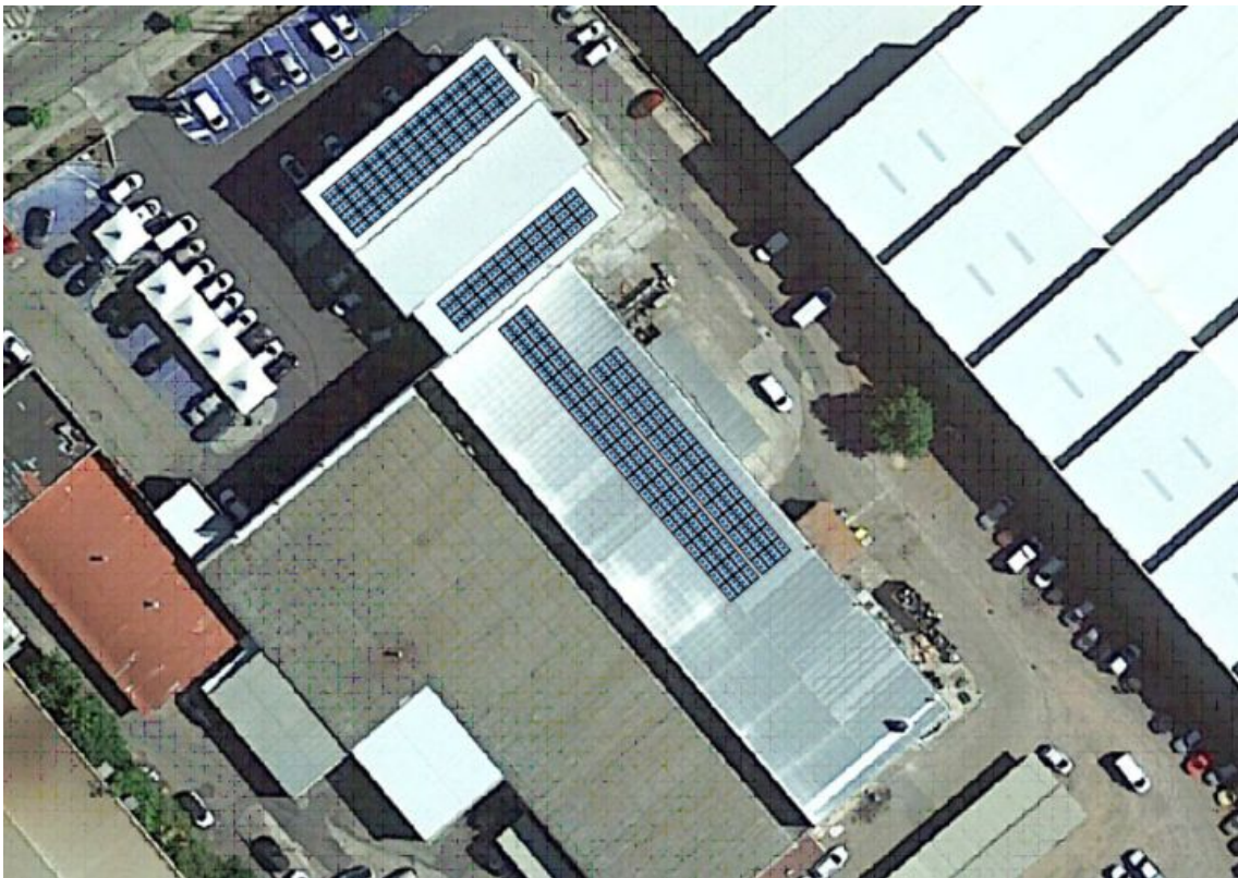
Imagen 10. Opción 1 - Configuración con todos los paneles coplanares
