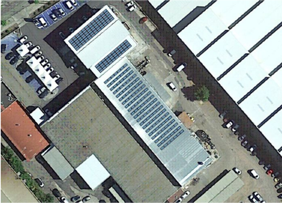
Imagen 11. Opción 2 - Configuración con paneles con la misma orientación
