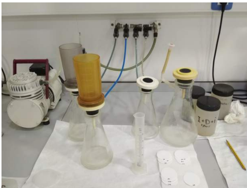
Figura S.1. Disposición de la bomba de vacío y puente de succión. Fuente: Imagen propia.
