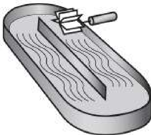
Figura M.1. Tanque tipo Raceway o HRAP (High Rate Algae Pond). Fuente: Imagen en línea.
