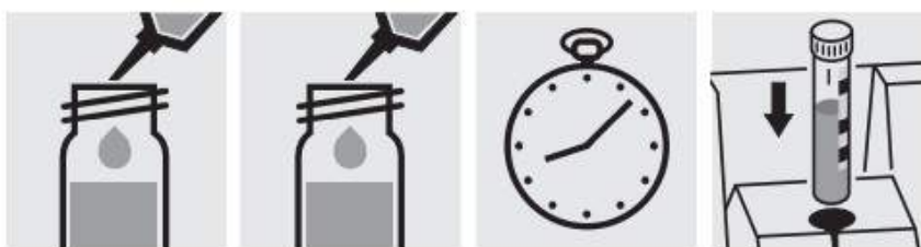
Figura S.11. Procedimiento de la medición de los nitratos. Fuente: Manual Spectroquant NOVA.
