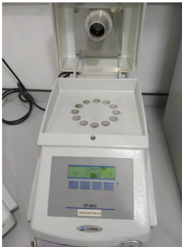
Figura S.15. Termorreactor. Fuente: Imagen propia.
