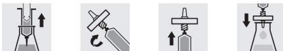
Figura S.7. Procedimiento de microfiltración. Fuente: Manual Spectroquant NOVA.
