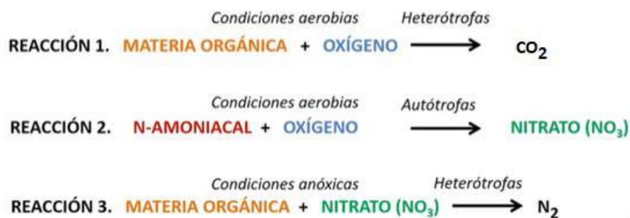
Figura M.4. Reacciones en el proceso de nitrificación y desnitrificación.
