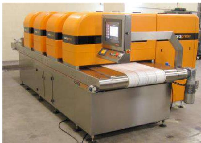
*Figura 3.2 Ejemplo de una impresora de pasada única en línea*
