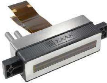
*Figura 3.10* Cabezal piezoeléctrico de impresión industrial DOD con 1000 boquillas y una anchura de impresión de 70 mm. Todas estas boquillas se pueden dirigir de forma individual
