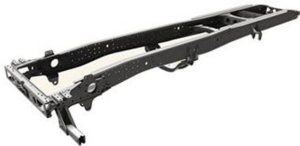
*Figura 11. Bastidor de un vehículo*
