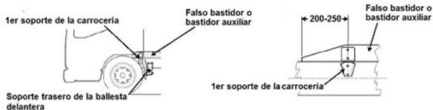
Figura 19. Colocación del larguero del falso bastidor
