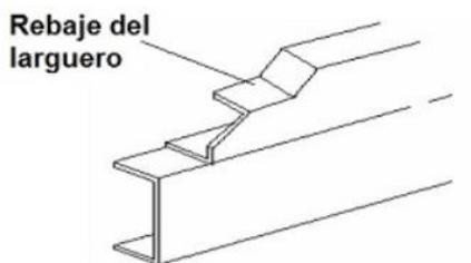
Figura 6. Rebaje del larguero de falso bastidor
