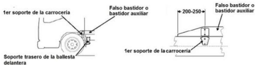
Figura 1. Distancia del bastidor auxiliar a la cabina
