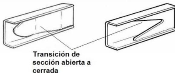
Figura 22. Transición de sección cerrada a abierta en largueros
