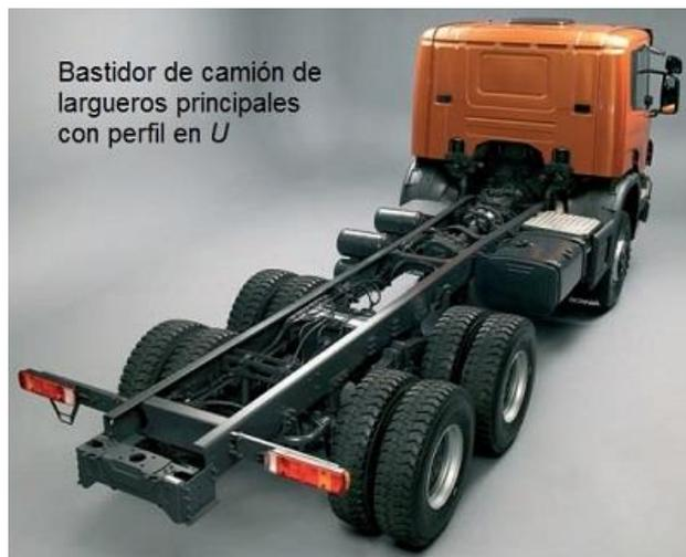
Figura 12. Bastidor de largueros longitudinales con perfil "U"
