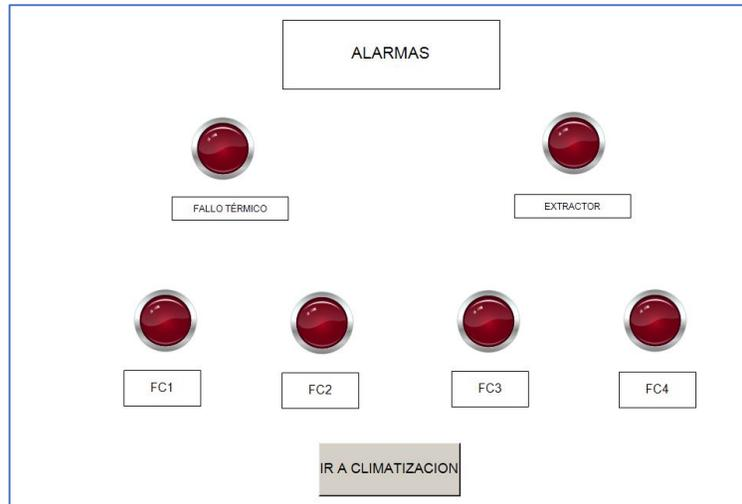
Imagen 17. Visualización de la pantalla que muestra las alarmas del sistema de climatización.
