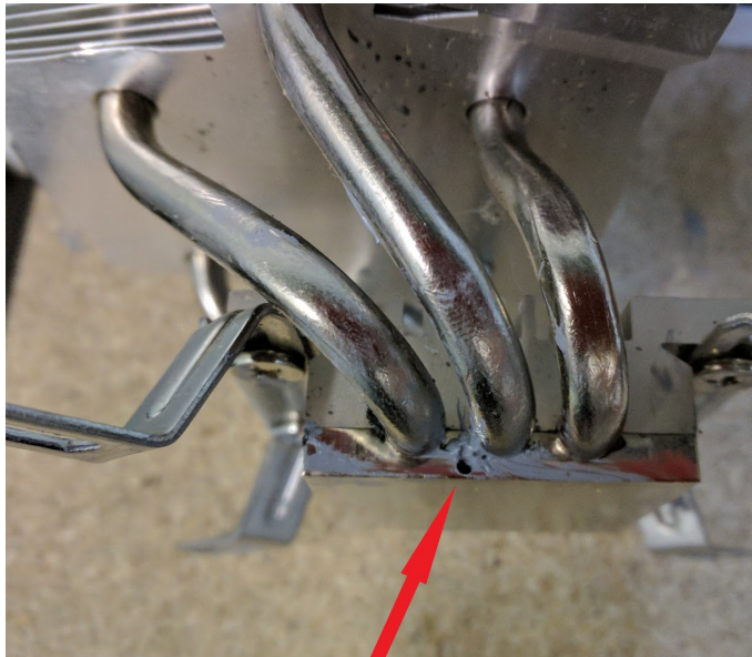
Figura 1.7-9: Orificio que mide la temperatura de la cara caliente de la célula Peltier para el disipador heat-pipe Katana 5.
