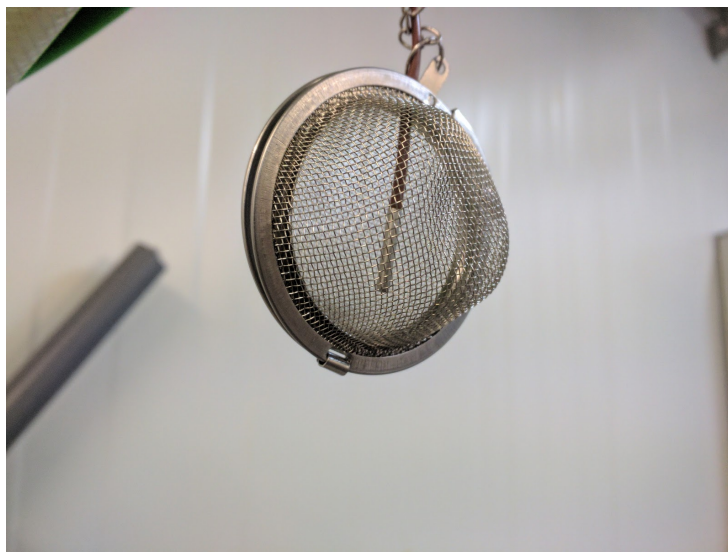
Figura 1.7-8: Montaje de la sonda que mide temperatura ambiente.
