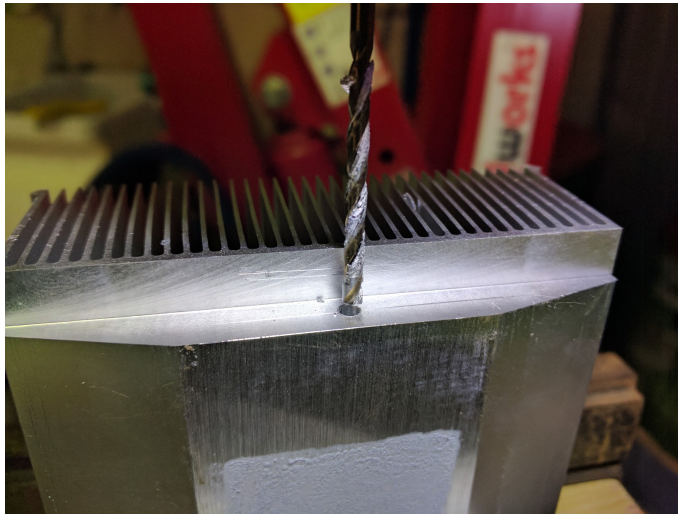
Figura 1.7-4: Orificio para situar el termopar que mide la temperatura del foco frío (Cara caliente).
