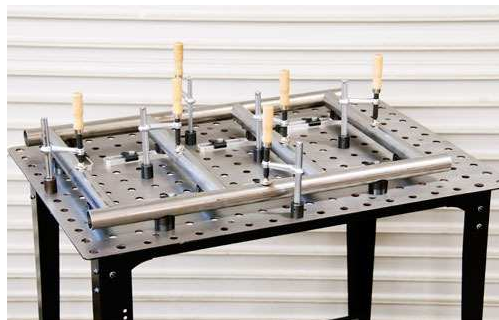
Fig 2. Mesa de soldadura de tubos metálicos con gatos hidráulicos regulables.
