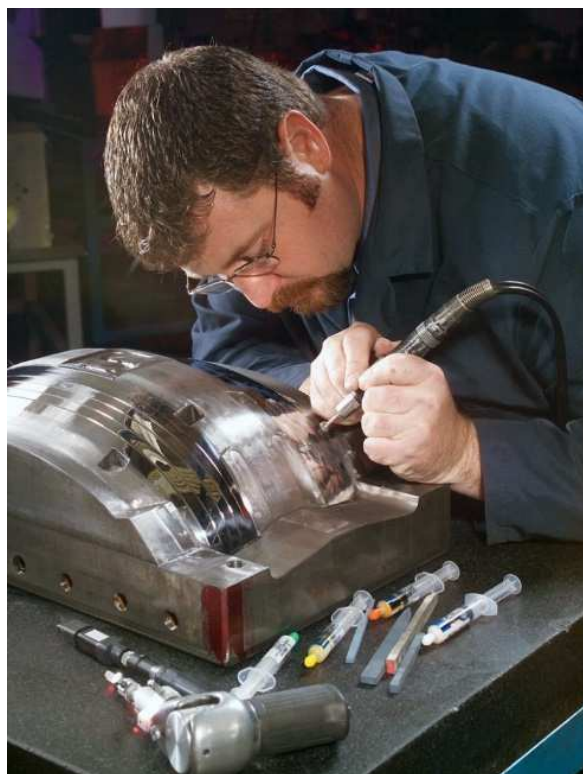
Fig 37. Operario realizando un pulido posterior de una de las partes de un molde.
