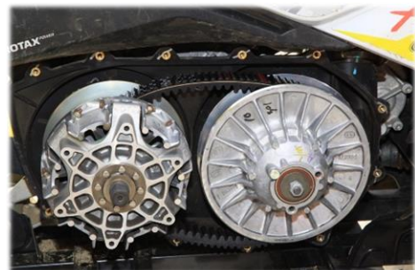
Ilustración 22 – Variador centrífugo con correa
