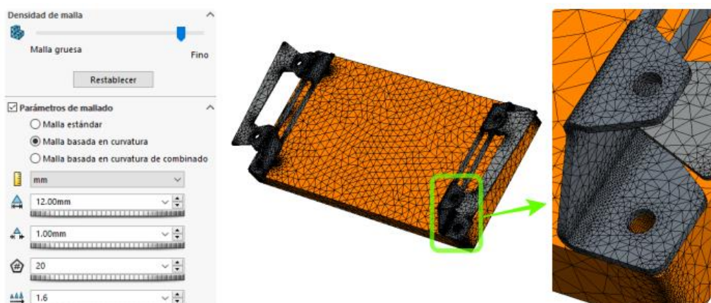
Ilustración 65 - Configuración mallado soporte controlador
