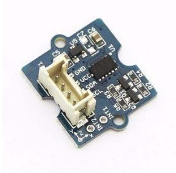
**Figura 7.23:** Módulo acelerómetro ADXL345 de SeeedStudio
