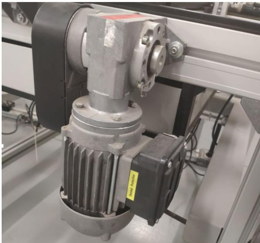
*Ilustración 13: Motor-reductor encargado de accionar una de las cintas transportadoras + relé de potencia*
