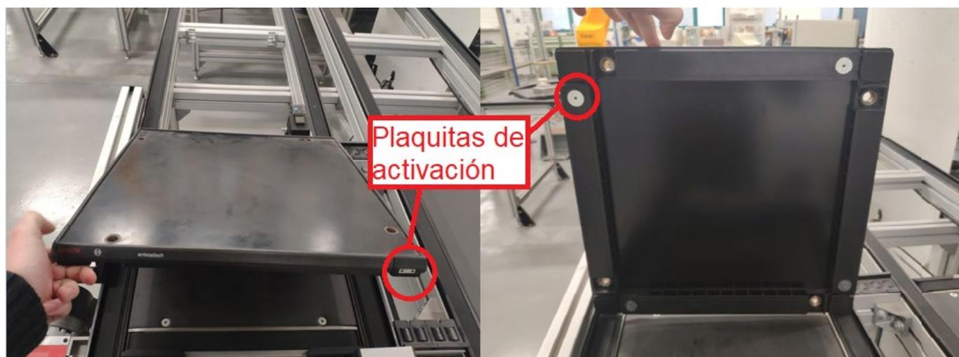
*Ilustración 2: Aspecto de los palets del sistema de transporte*
