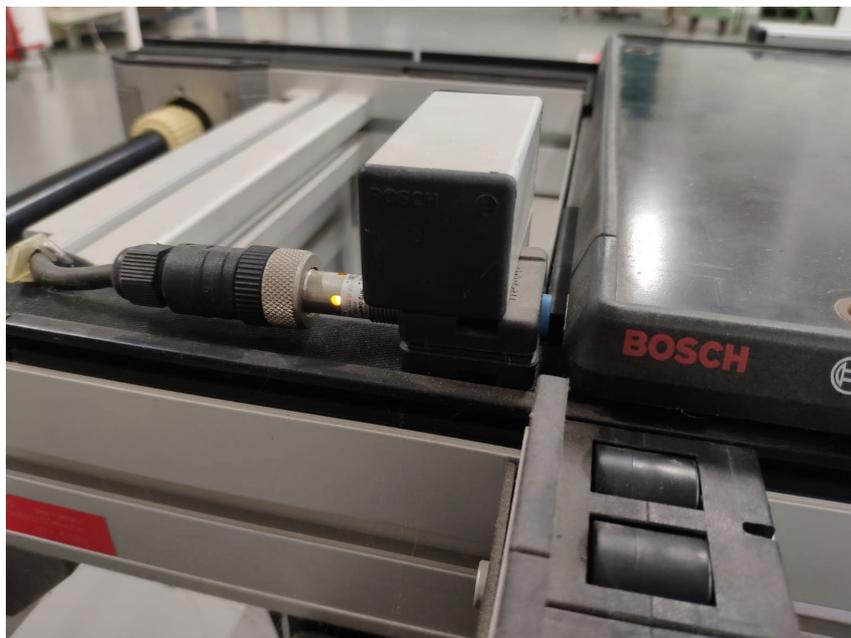
*Ilustración 10: Sensor de proximidad inductivo detectando plaquita de activación*
