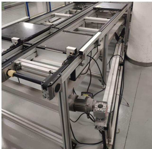
*Ilustración 56: Unidad modular de transporte desmontada por limitación de espacio*
