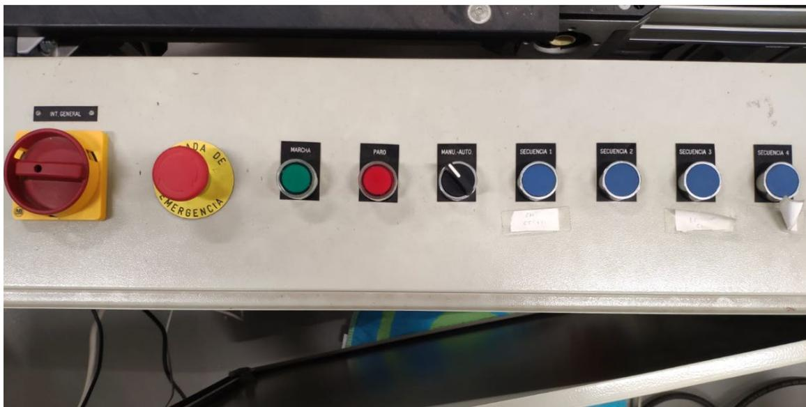
*Ilustración 7: Pulsadores e interruptores del sistema situados sobre el cuadro eléctrico*
