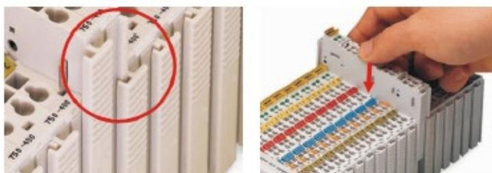
Ilustración 47: Manera de insertar los módulos I/O WAGO
