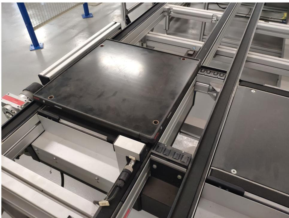
*Ilustración 5: Medios de transporte (2). Cinta + rodillos EQ 2/TR*
